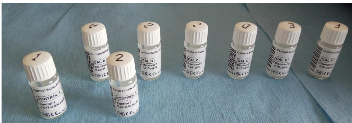
Figura 18. Componentes estándar en diferentes concentraciones (A 0µg/dL; B 0,015 µg/dL; C 0,04 µg/dL; D 0,17 µg/dL; E 0,7 µg/dL; F 3 µg/dL) y Control (1: 0,47-0,098 µg/dL; 2: 0,37-0,69 µg/dL)
