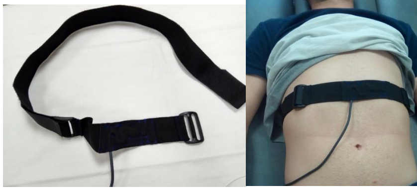
Figura 8. Sensor de respiración (izquierda) y colocación del sensor en el sujeto (derecha).
