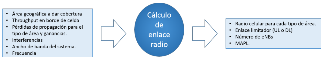
Figura 3.6: Entradas y salidas para cálculo de enlace radio. (Fuente: elaboración propia a partir de [51]).
