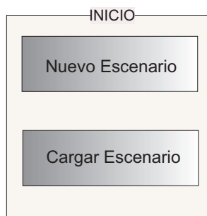
Figura 6.2: Ventana inicial. Permite cargar un escenario que contiene un conjunto de datos sobre el entorno a simular (Rural, Urbano, Suburbano o Denso) y sobre las características de la red LTE y de los servicios a prestar.
