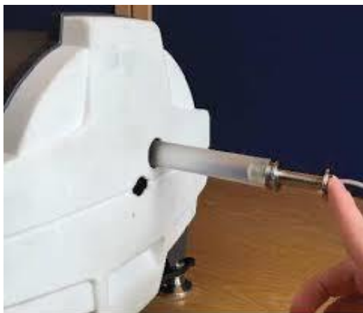
Figura 3 Alloggiamento per la camera a ionizzazione
