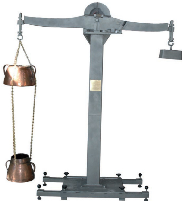
Figura 1. Uma reprodução física da balança de dois baldes de Galileu: o balde superior é preenchido com água e tem um orifício no seu fundo. No início do experimento o orifício encontra-se fechado, e a balança está em equilíbrio. Quando o orifício é aberto, a água escoar para o balde inferior. Inicialmente a balança desloca-se para o lado do contrapeso, e após o jato percutir o balde inferior o equilíbrio é restabelecido. Essa balança encontra-se na Universidade de Pávia, Itália 3 .
