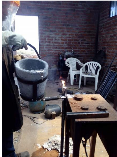
Figura 5-3: Deposición del fundido en los moldes
