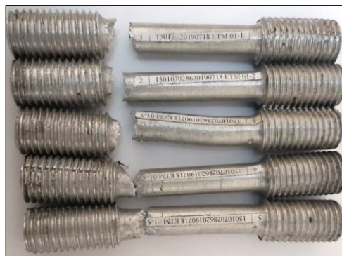
Figura 16-3: Probetas rotas con 1% Cu
