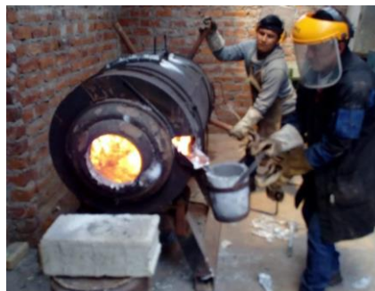
Figura 4-3: Extracción de la colada del horno
