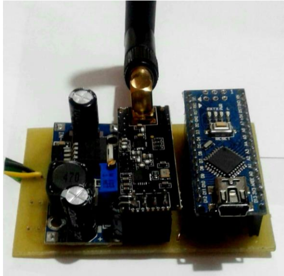
Figura 59-3: Montaje de la placa PCB.
