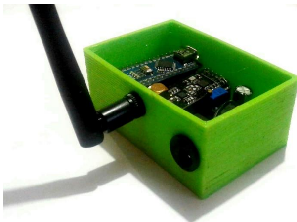
Figura 64-3: Impresión 3D de la caja protectora.
