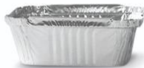
Figura 8-2: Moldes de aluminio para determinar densidad del suelo.
