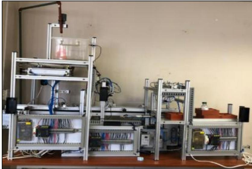
**Figura 100- 3:** Sistema de embotellado.
