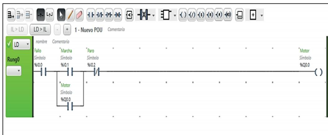
**Figura 79- 2:** Ejemplo de programación LD en SoMachine Basic.
