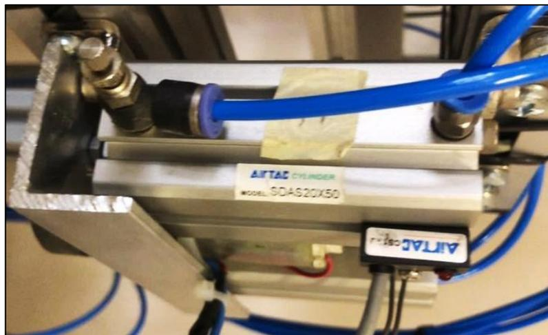
**Figura 52- 2:** Pistón neumático.
