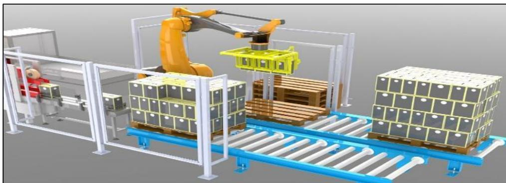
**Figura 37- 1:** Sistema de paletizado de botellas por brazo robótico.
