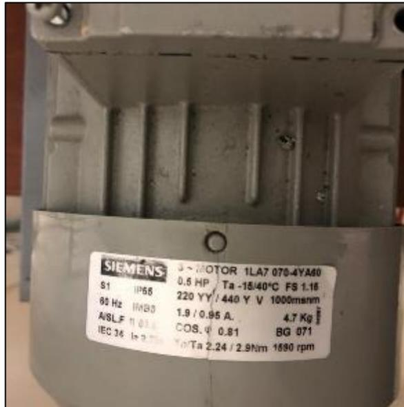
**Figura 53- 2:** Motor trifásico Siemens 0.5 HP
