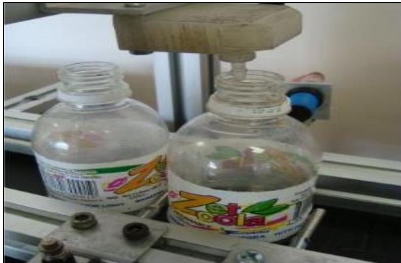
**Figura 95- 3:** Etapa de dosificado, comprobación de funcionamiento.
