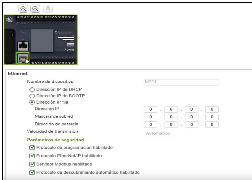
**Figura 81- 2:** Configuración de Ethernet en SoMachine Basic.
