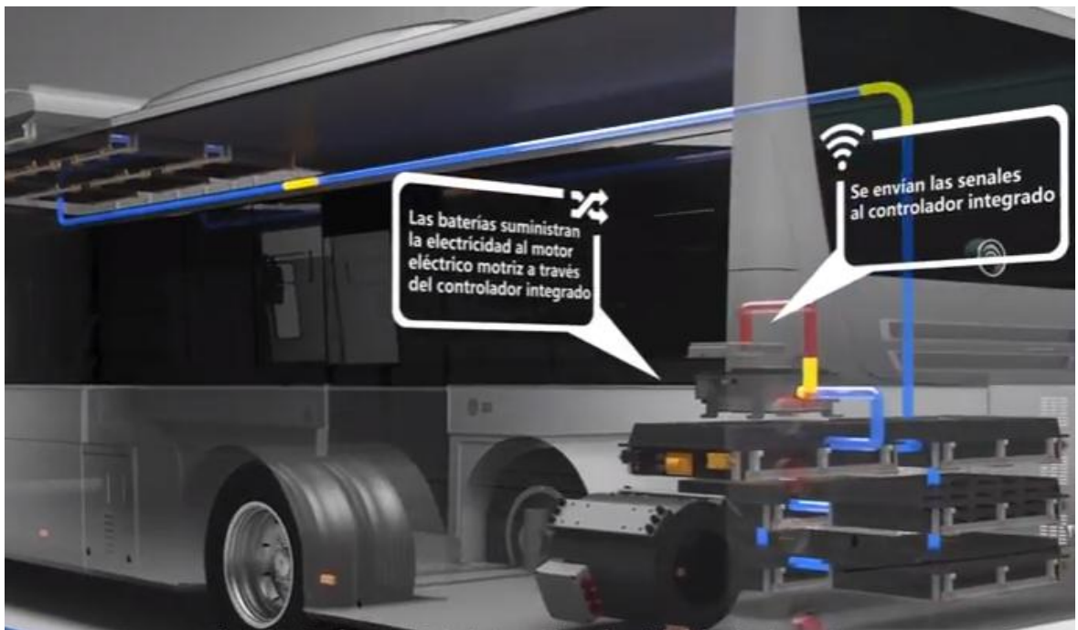
Figura 3.1 Funcionamiento del sistema eléctrico
