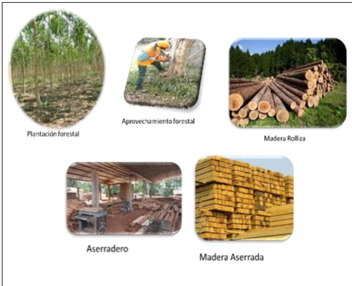
Figura 2.2 Proceso productivo de madera aserrada.
