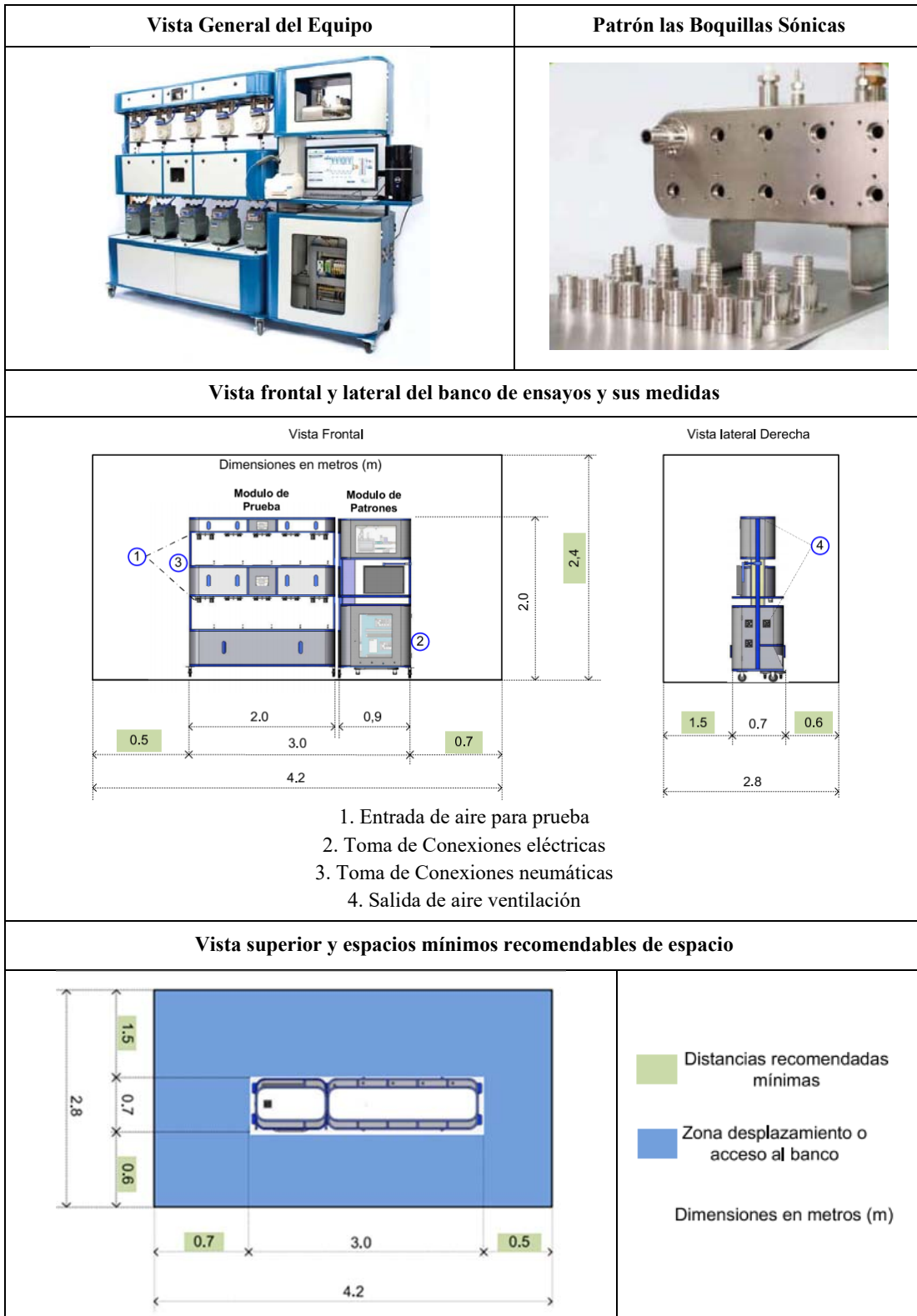
Figura 7.5. Detalles del banco de contrastación.
