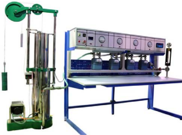
Figura 5.10. Banco de ensayo para contrastación de medidores de gas del fabricante Nagman Lab (India).
