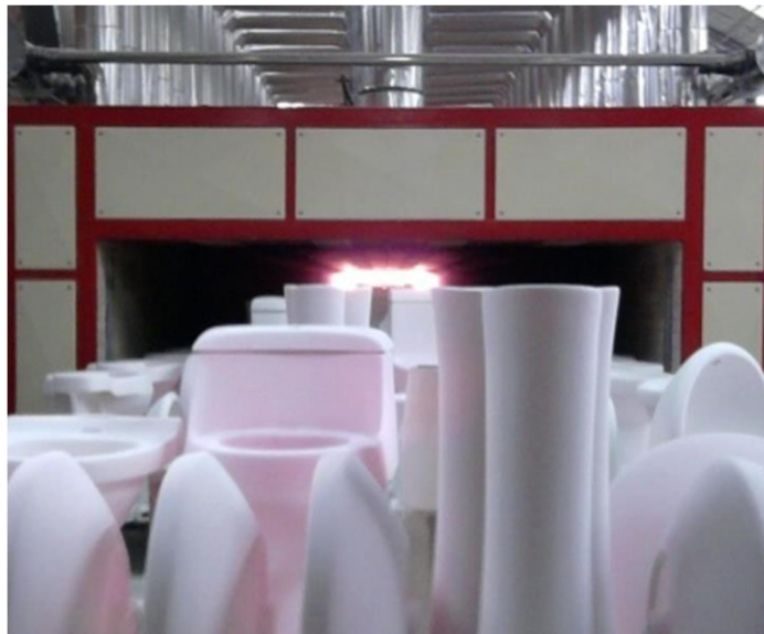
Figura 24: Ingreso de piezas al horno. Fuente: Empresa VITRESA.
