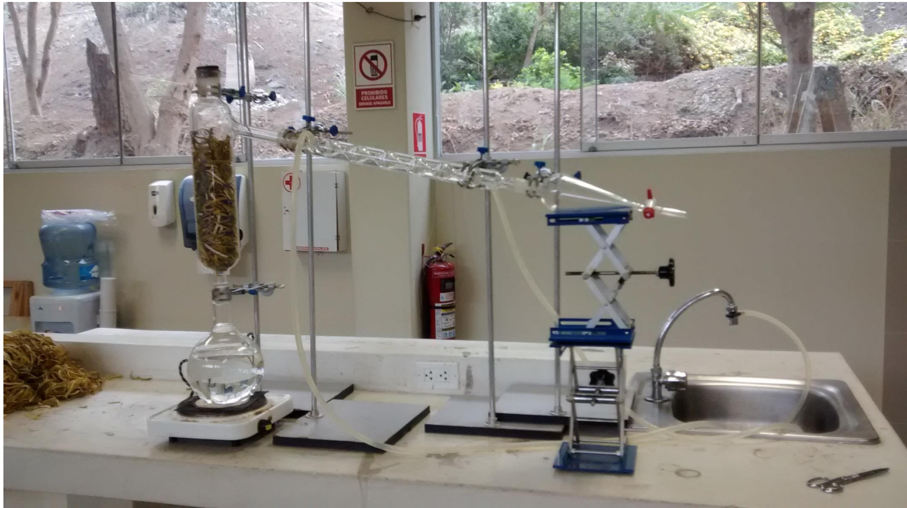
Figura 74. Extracción de aceite esencial de naranja método clásico (Elaboración propia)
