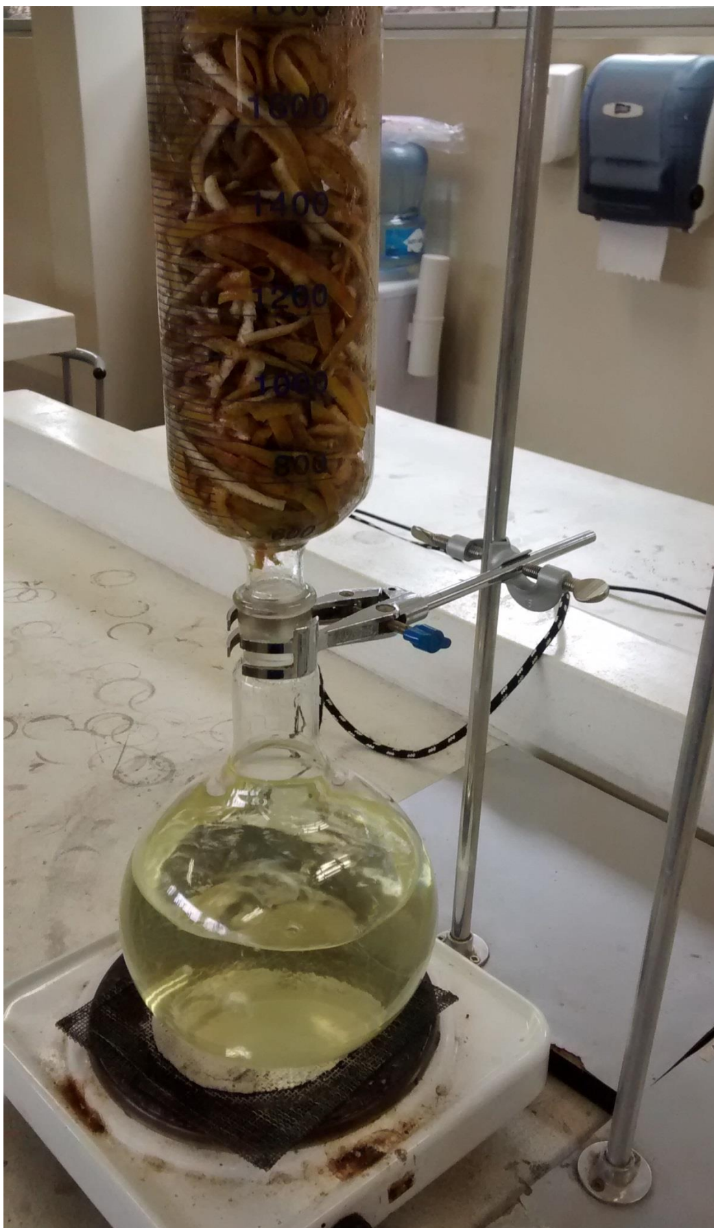
Figura 106. Extracción de aceite esencial de tangelo método clásico (Elaboración propia)
