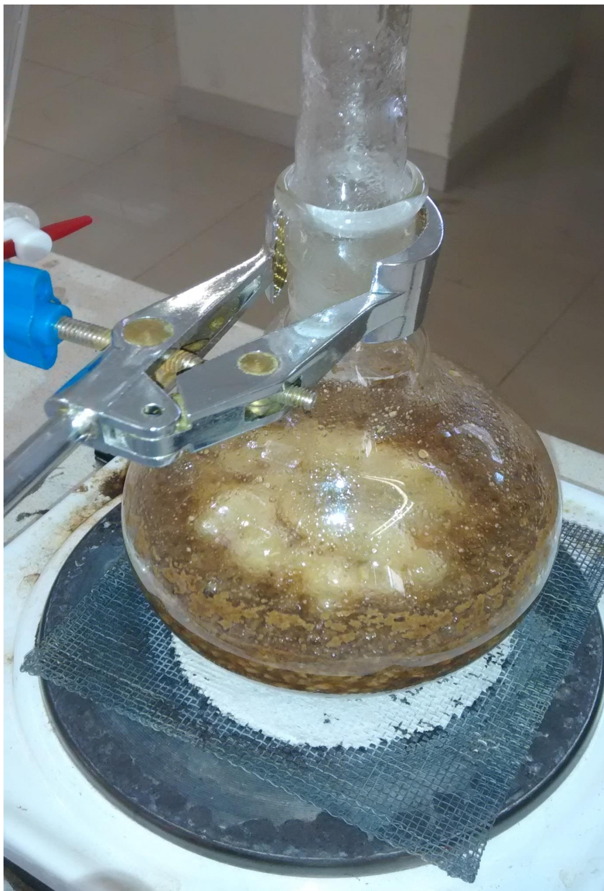
Figura 78. Extracción de aceite esencial de naranja método Clevenger (Elaboración propia)
