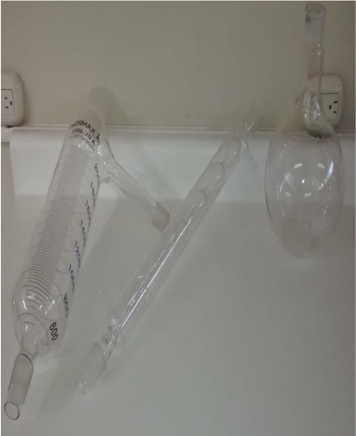
Figura 34. Equipo para extracción de aceites esenciales por arrastre con vapor clásico (Elaboración propia)
