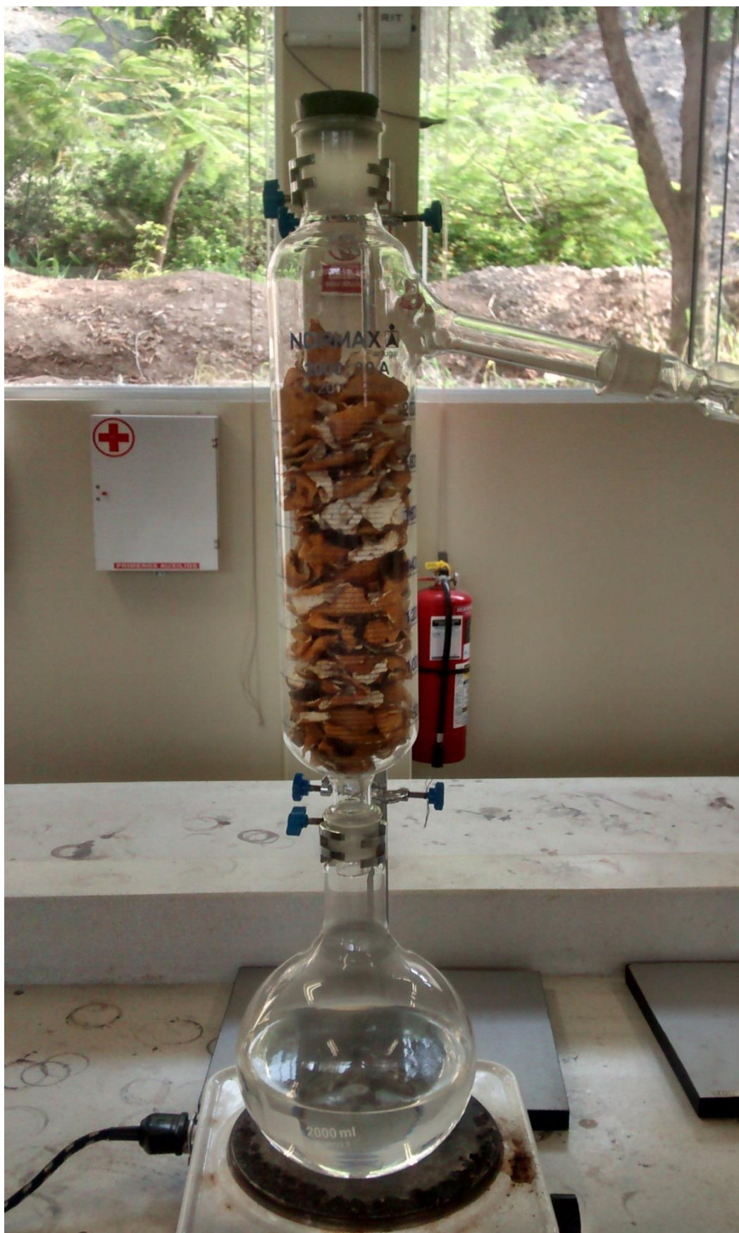
Figura 89. Extracción de aceite esencial de mandarina método clásico (Elaboración propia)
