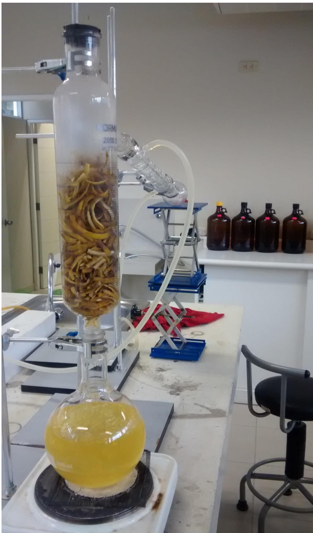
Figura 76. Extracción de aceite esencial de naranja método clásico (Elaboración propia)
