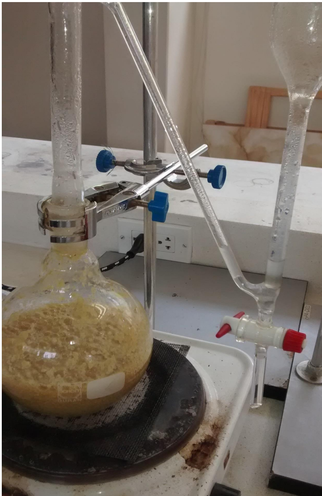
Figura 93. Extracción de aceite esencial de mandarina método Clevenger (Elaboración propia)
