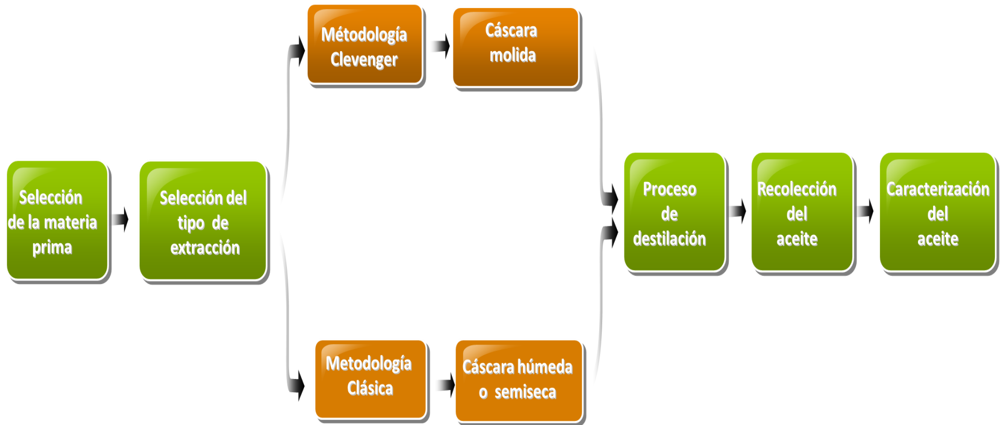
Figura 36. Esquema del proceso experimental para la extracción de aceites esenciales de naranja, mandarina y tangelo mediante arrastre de vapor clásico y Clevenger (Elaboración propia)
