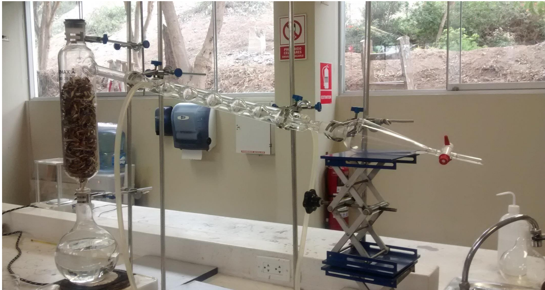
Figura 104. Extracción de aceite esencial de tangelo método clásico (Elaboración propia)
