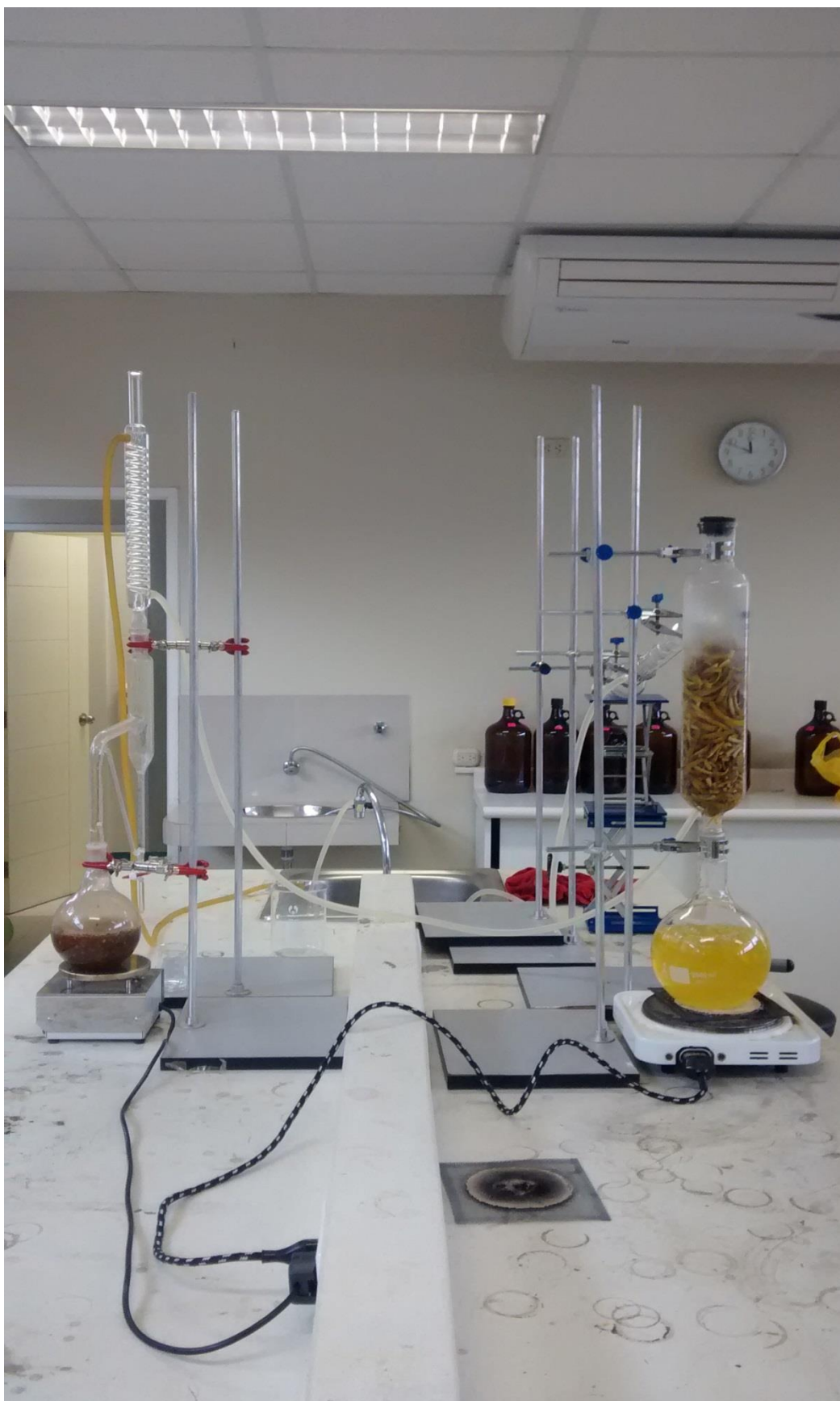
Figura 124. Prueba comparativa de extracción de aceite esencial de naranja por los métodos clásico y Clevenger (Elaboración propia)
