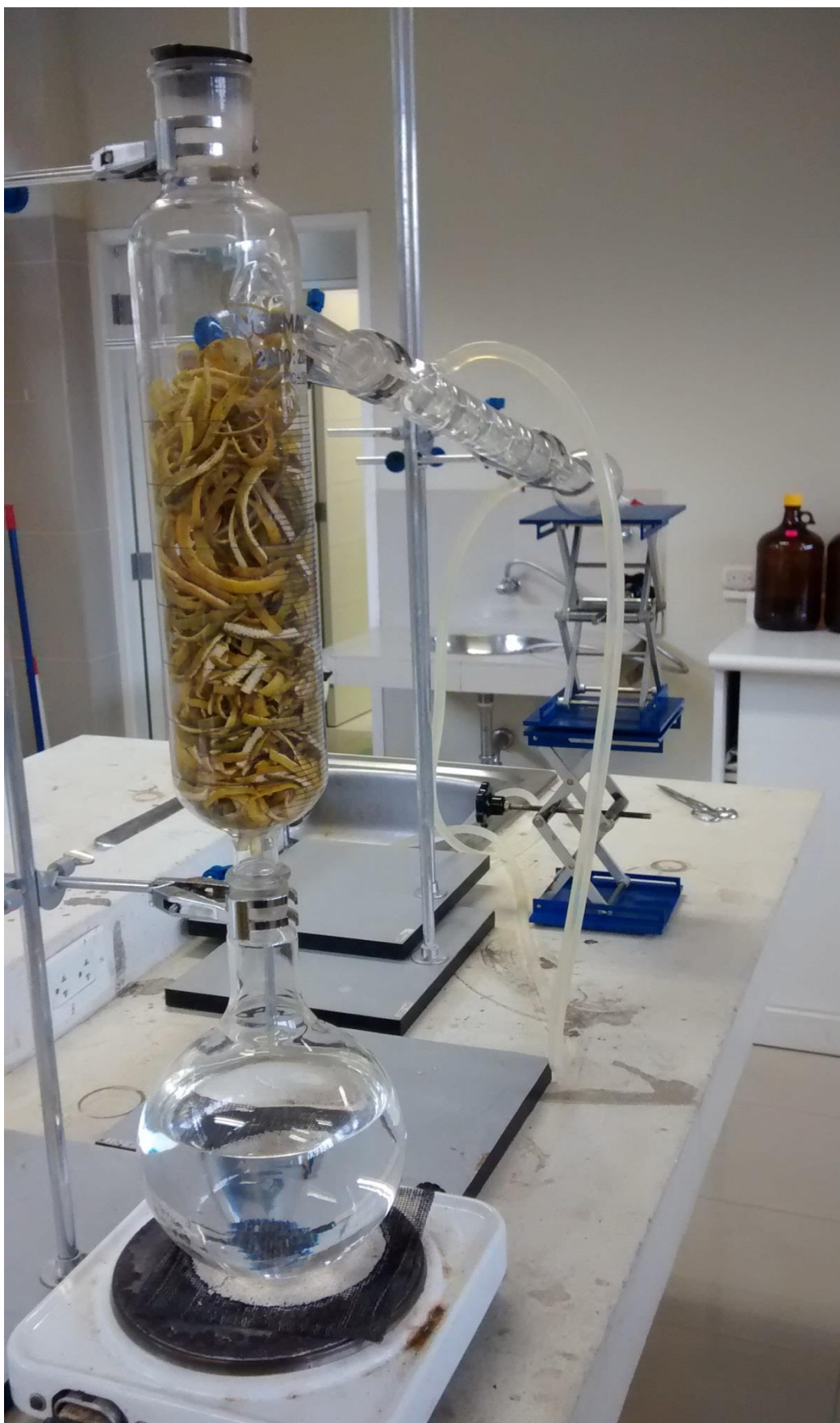
Figura 75. Extracción de aceite esencial de naranja método clásico (Elaboración propia)
