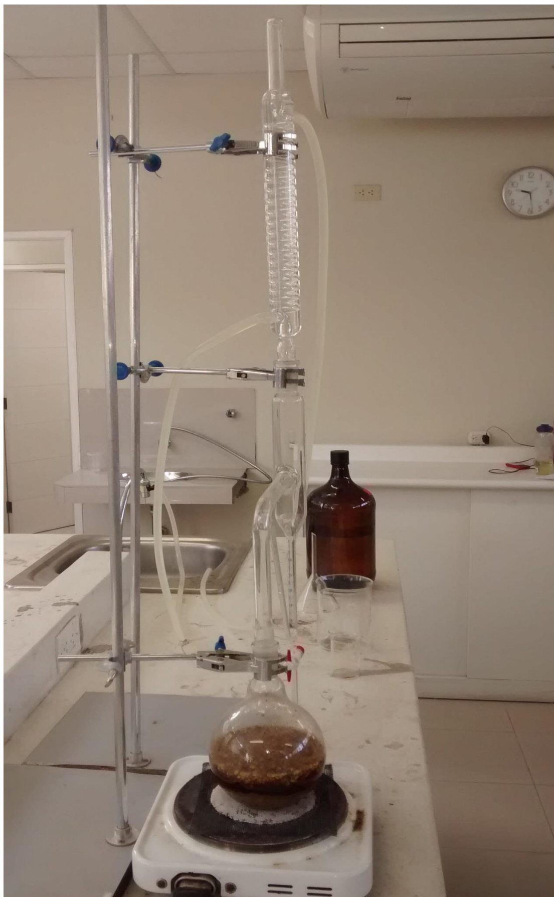
Figura 77. Extracción de aceite esencial de naranja método Clevenger (Elaboración propia)
