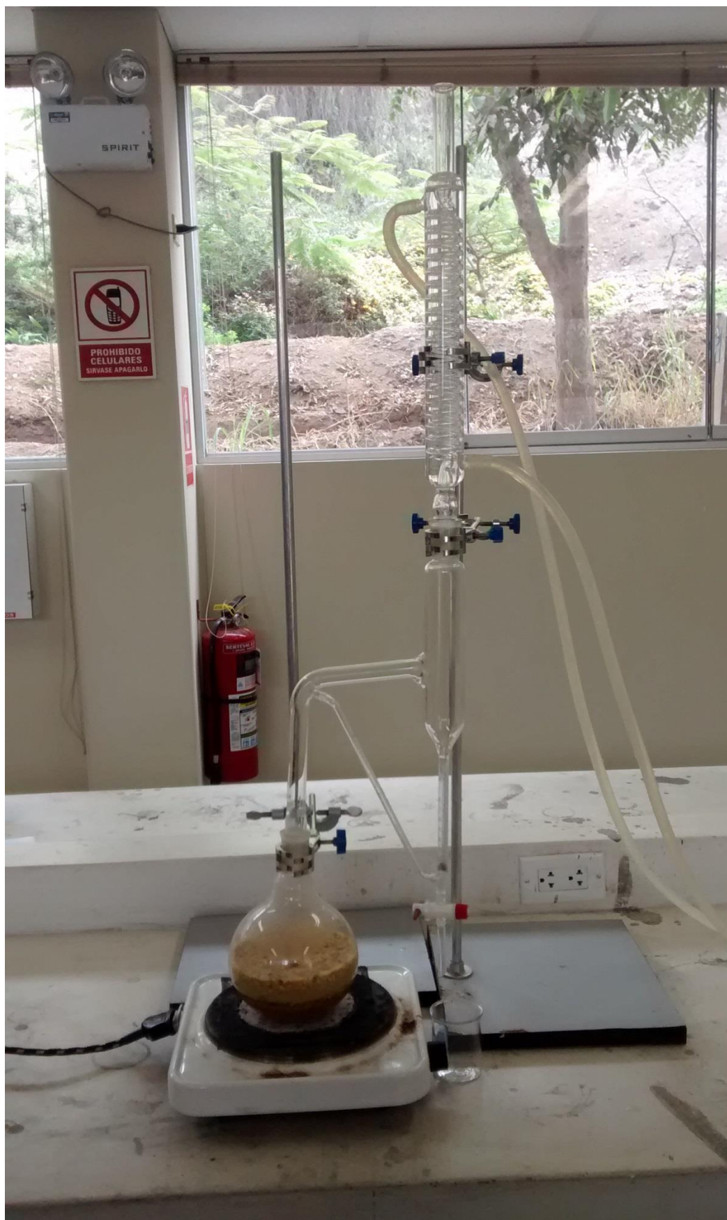
Figura 107. Extracción de aceite esencial de tangelo método Clevenger (Elaboración propia)
