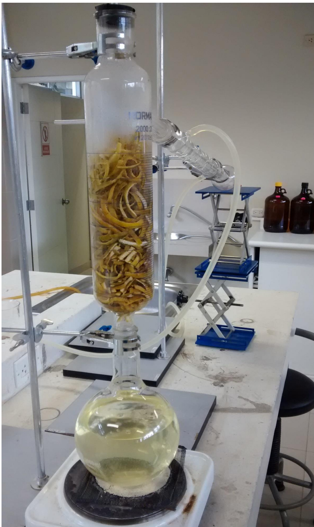
Figura 105. Extracción de aceite esencial de tangelo método clásico (Elaboración propia)
