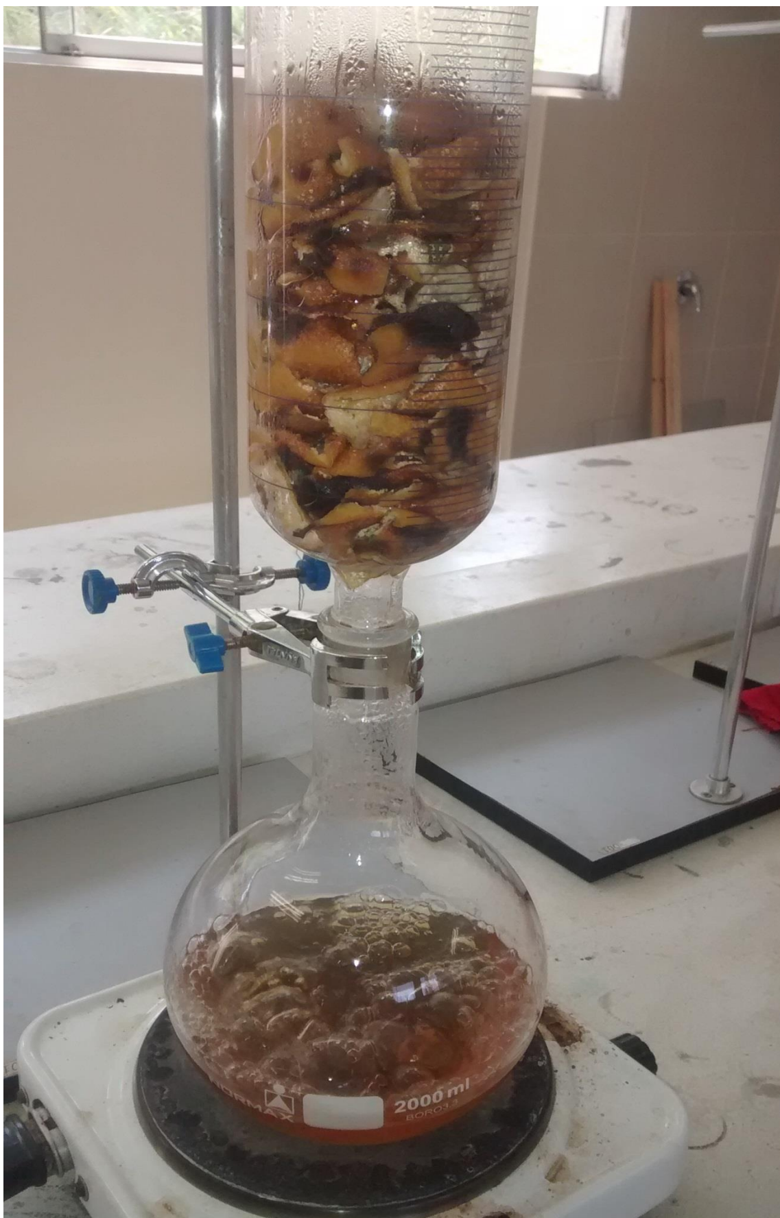
Figura 91. Extracción de aceite esencial de mandarina método clásico (Elaboración propia)
