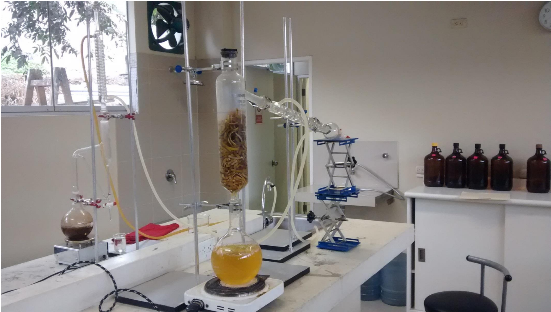
Figura 125. Prueba comparativa de extracción de aceite esencial de naranja por los métodos clásico y Clevenger (Elaboración propia)
