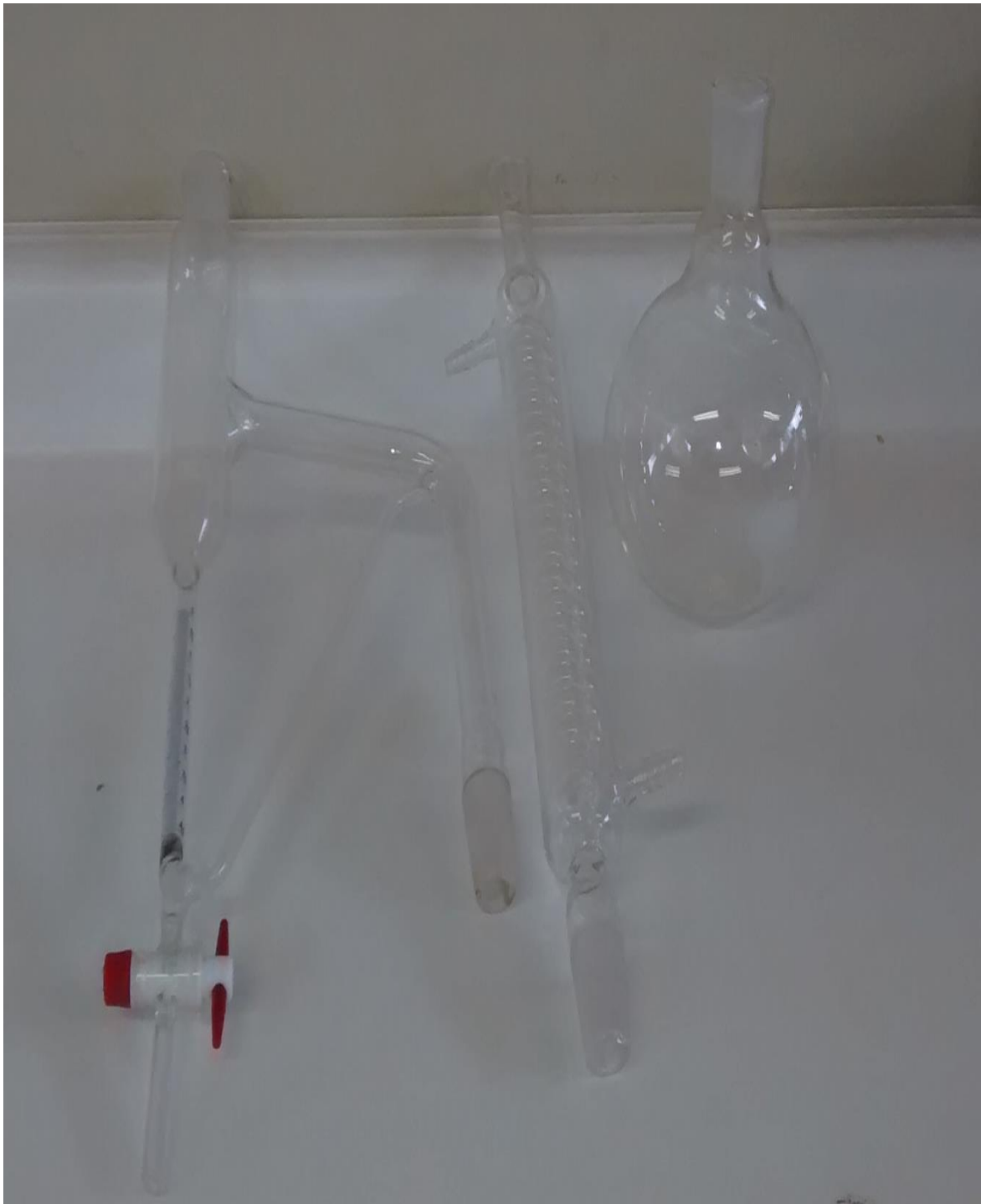
Figura 35. Equipo para extracción de aceites esenciales por arrastre con vapor Clevenger (Elaboración propia)
