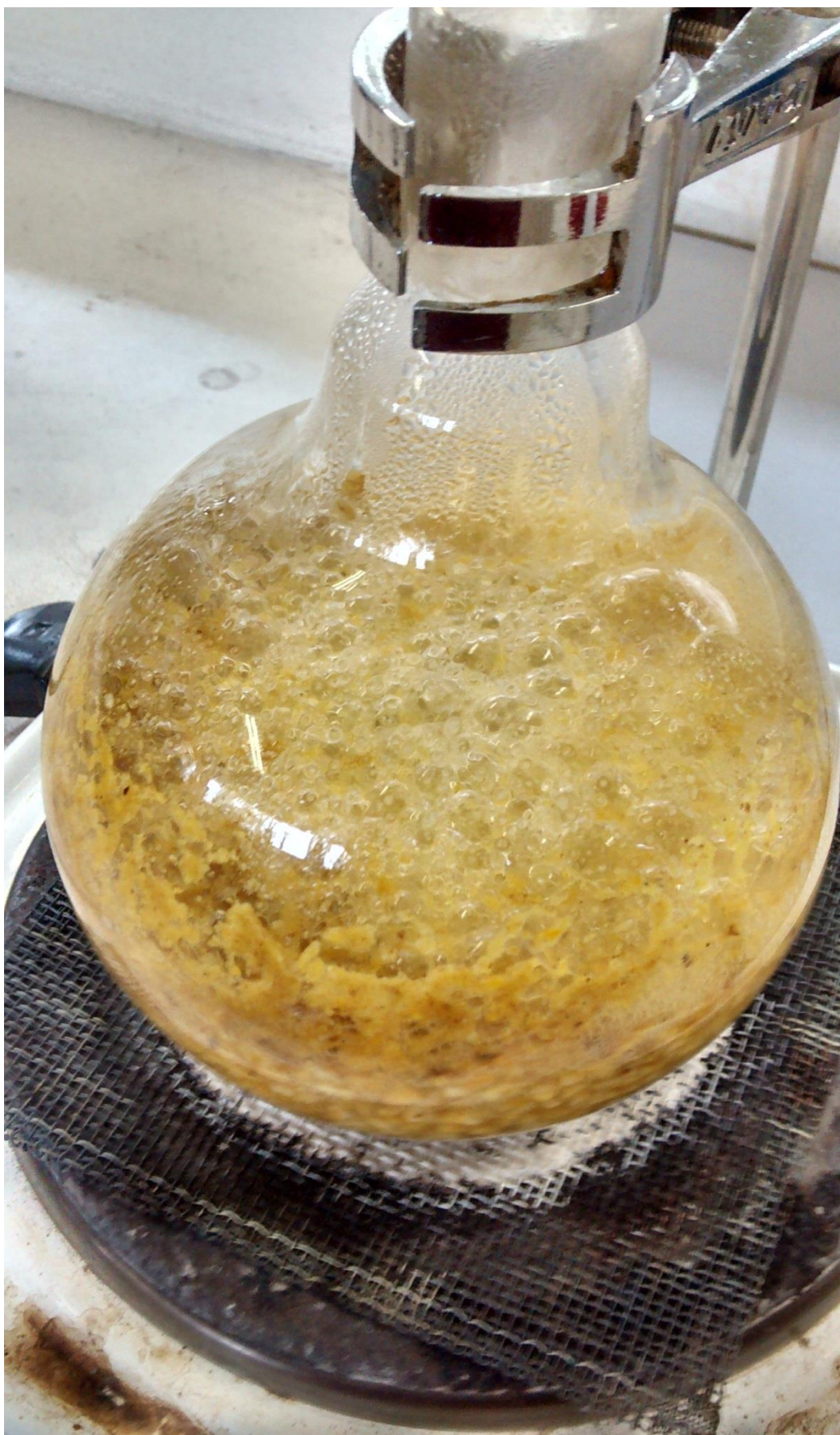
Figura 108. Extracción de aceite esencial de tangelo método Clevenger (Elaboración propia)
