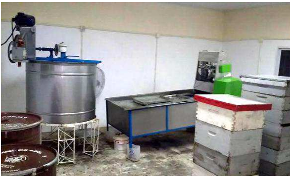
Foto N°10: Extractor, batea y desoperculador de la Sala del Tatú. Fuente: Gentileza Escuela del Tatú.
