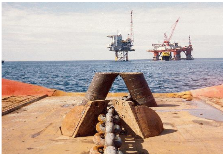
Figure 4: Shark Jaws and Guide Pins. Source: Escola Politécnica Engenharia Naval e Oceanica COPPE Universidade Federal do Rio de Janeiro.
