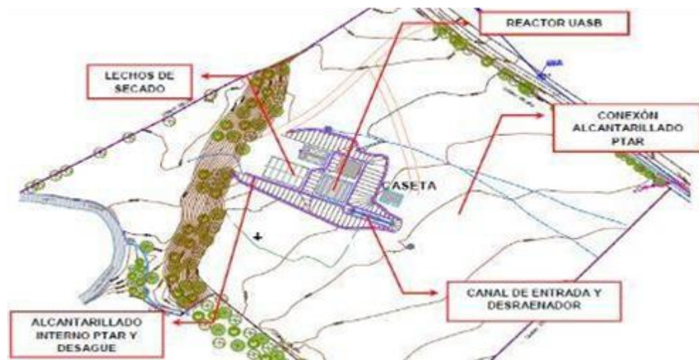
Ilustración 4 Estructuras Internas PTAR Guasca Cundinamarca
