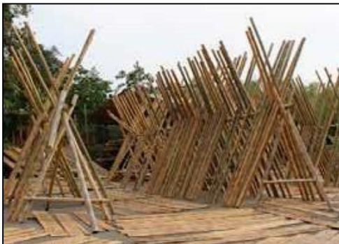
Figura 2. Secado al Ambiente de la Guadua
