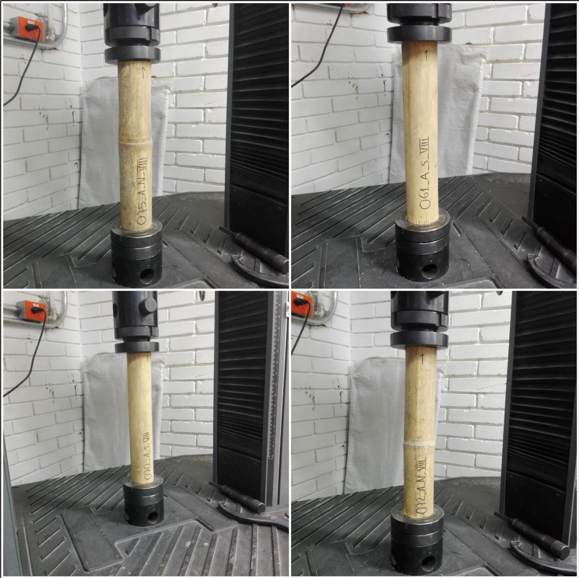
Figura 37. Registro fotográfico ensayo a compresión paralela, probetas de 5 cm
