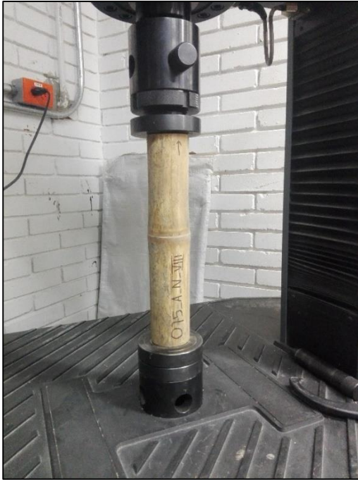
Figura 22. Ensayo a compresión muestra de 5 cm de diámetro
