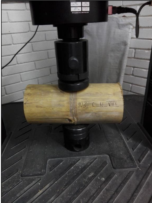
Figura 27. Ensayo a compresión perpendicular muestra de 15 cm de diámetro
