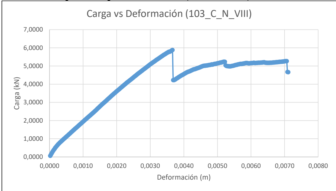
Gráfica 35. Diagrama carga vs deformación (103_C_N_VIII)
