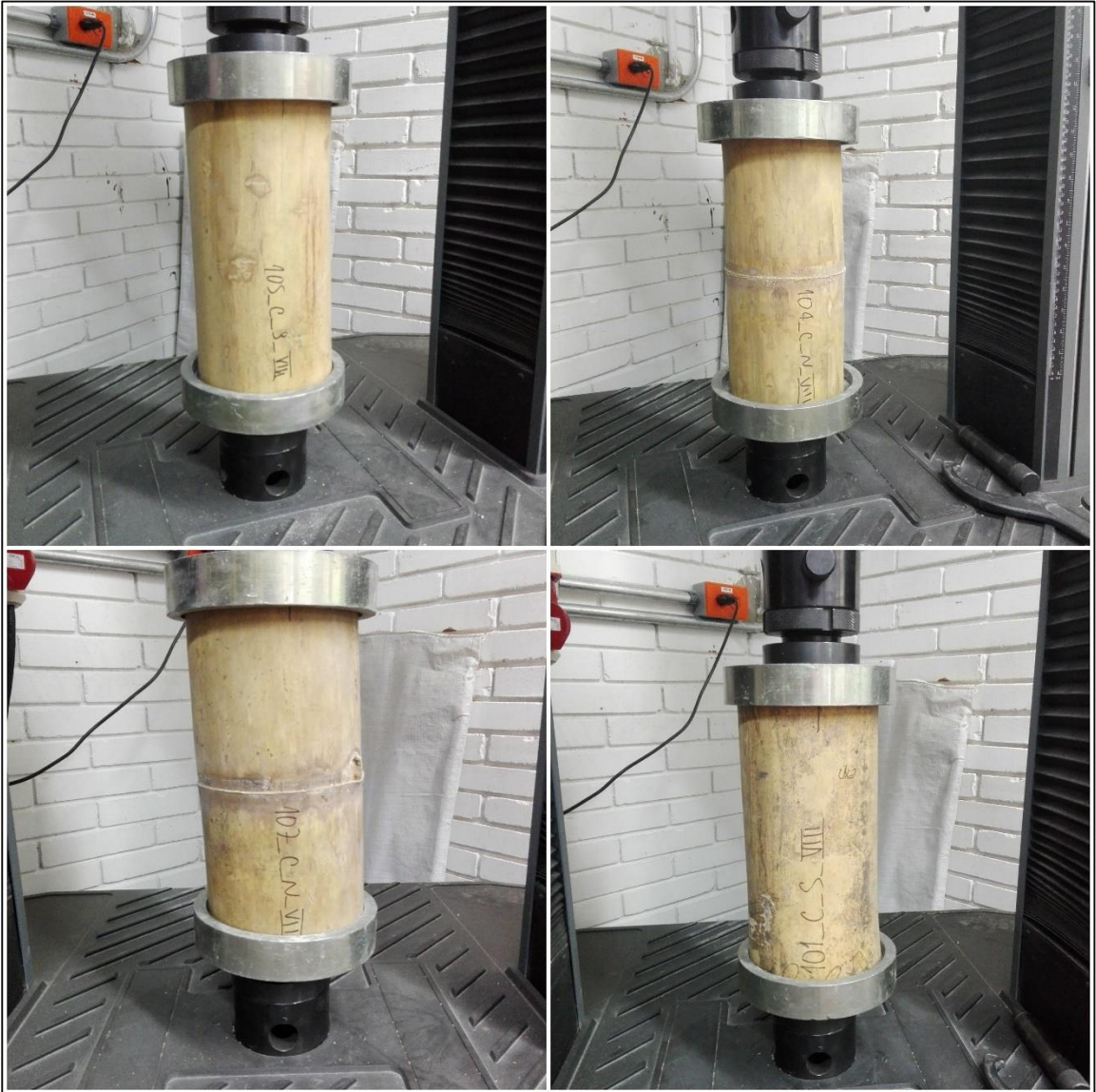
Figura 39. Registro fotográfico ensayo a compresión paralela, probetas de 15 cm
