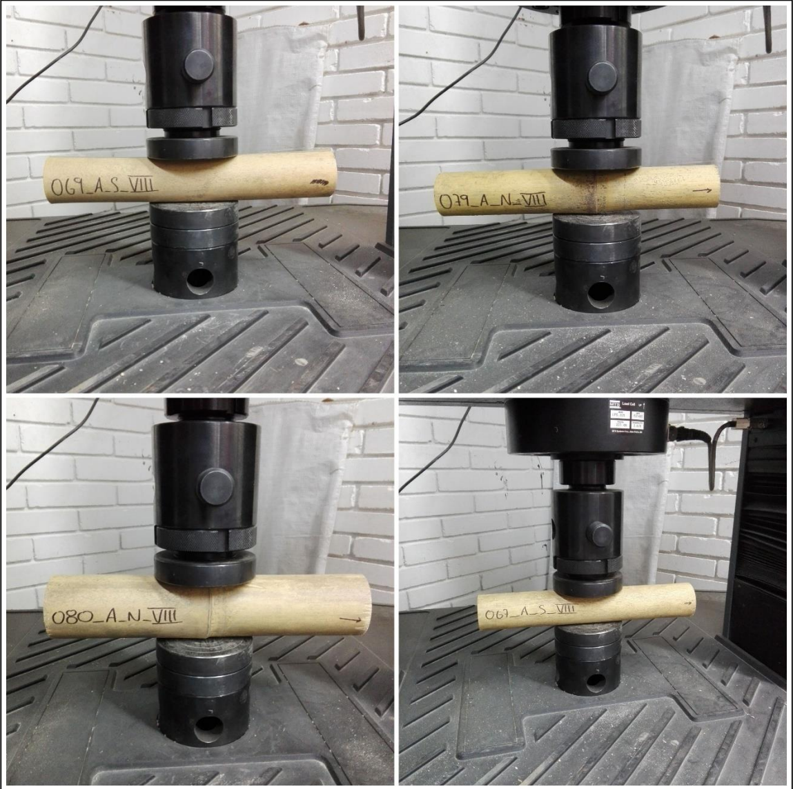
Figura 40. Registro fotográfico ensayo a compresión perpendicular a la fibra, probetas de 5 cm
