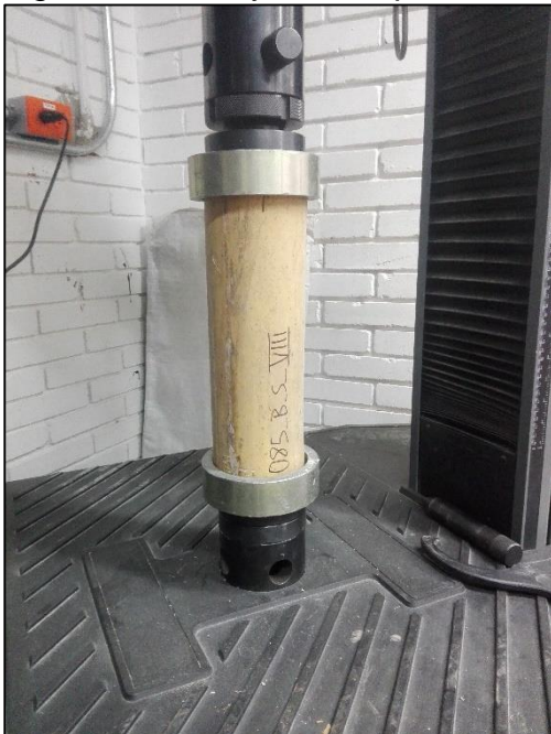
Figura 23. Ensayo a compresión muestra de 10 cm de diámetro
