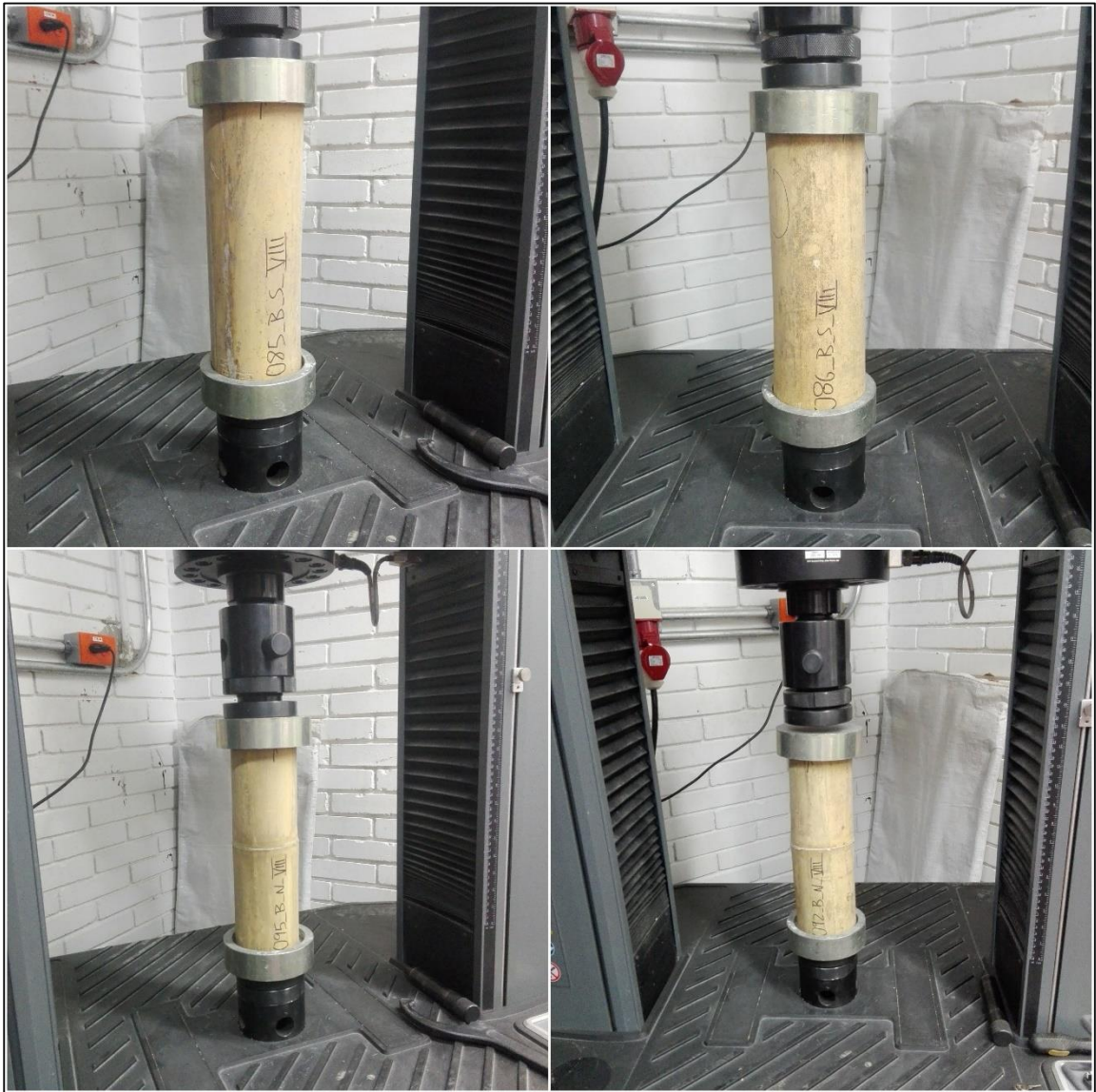
Figura 38. Registro fotográfico ensayo a compresión paralela, probetas de 10 cm
