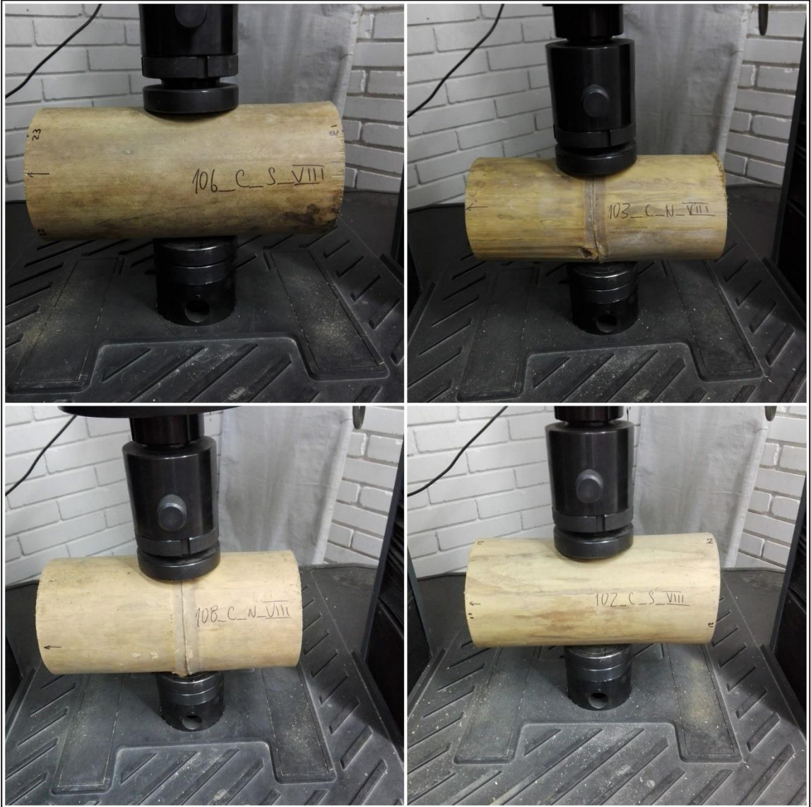
Figura 42. Registro fotográfico ensayo a compresión perpendicular a la fibra, probetas de 15 cm
