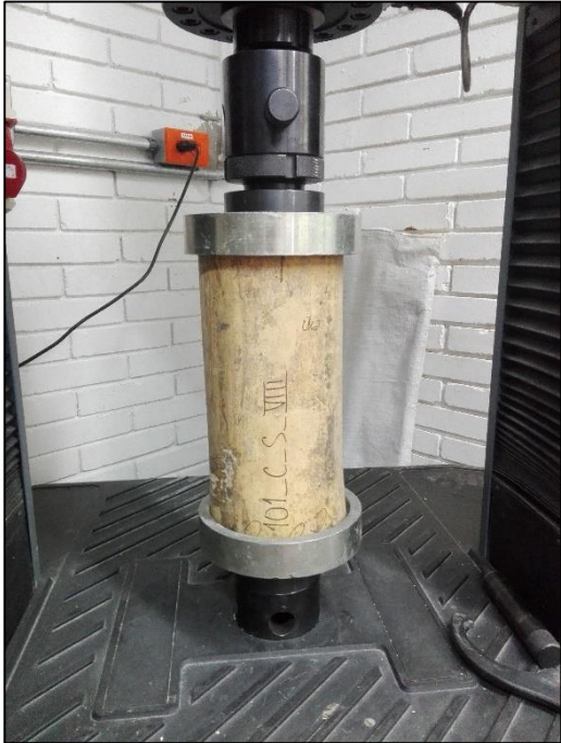
Figura 24. Ensayo a compresión muestra de 15 cm de diámetro
