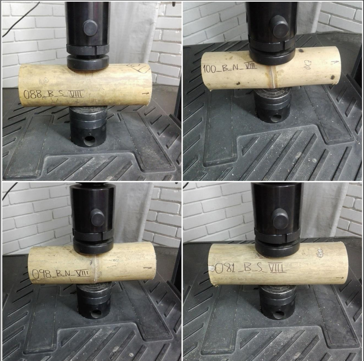
Figura 41. Registro fotográfico ensayo a compresión perpendicular a la fibra, probetas de 10 cm
