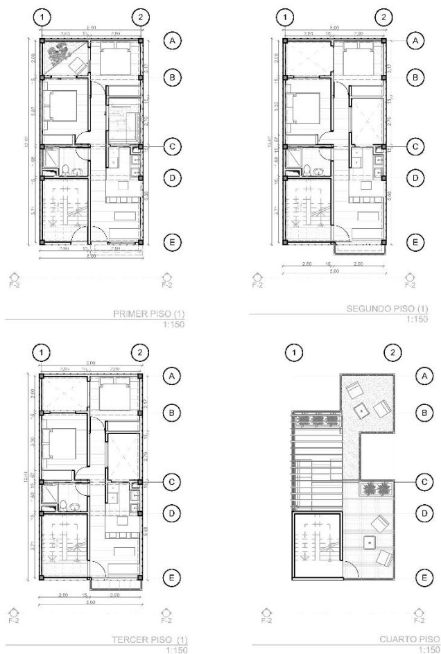
figura 10 Propuesta de vivienda aislada 6 metros x 12 metros Fuente: Elaboración propia, 2019
