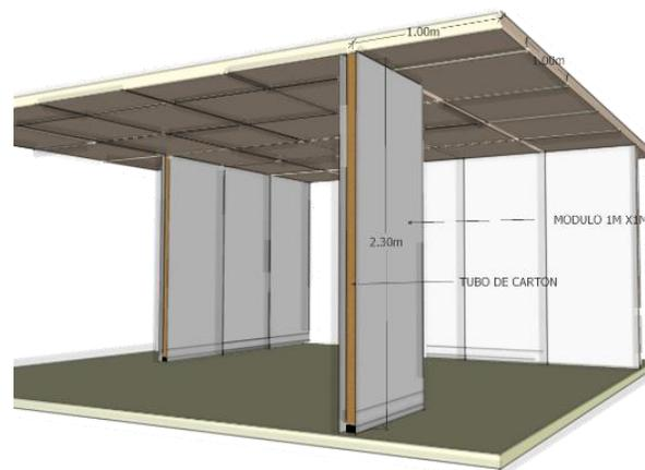
Figura 22: Funcionamiento de módulo de muro móvil
