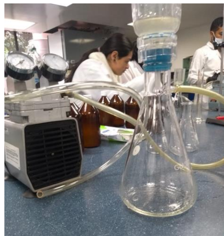
Figura 35. Filtración de la muestras.
