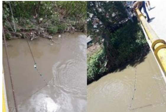
Figura 40. Medición del caudal con Molinete.
