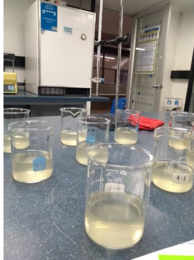
Figura 34. Muestras para la medición de Fósforo.
