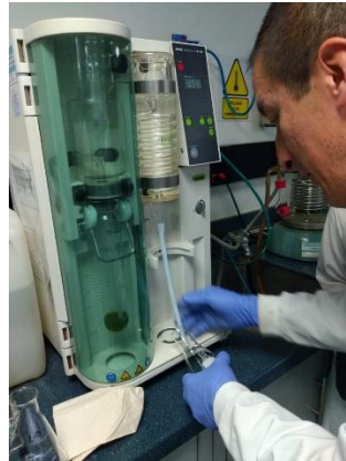
Figura 33. Destilación del proceso Kjeldahl.
