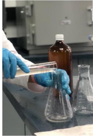
Figura 28. Toma de muestras para el procedimiento de Alcalinidad.
