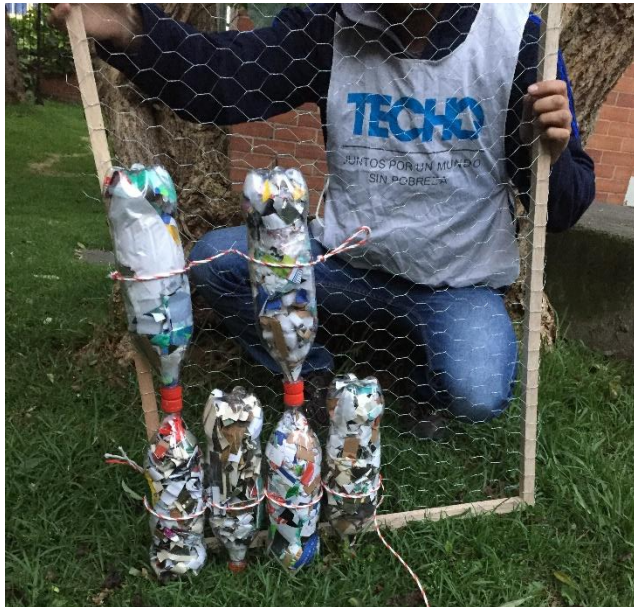
Figura 23. Muro de prueba construido con Ecoladrillos.
