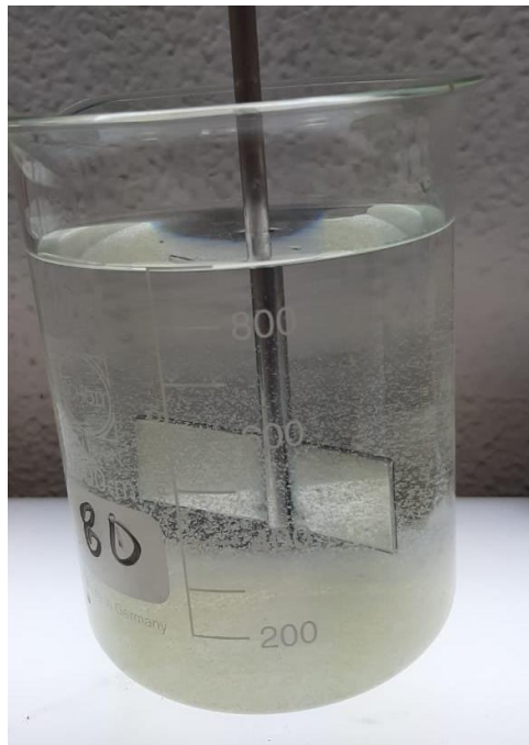
Fig. No 28, Expectativa de flóculos para una muestra de 80 ml de coagulante
