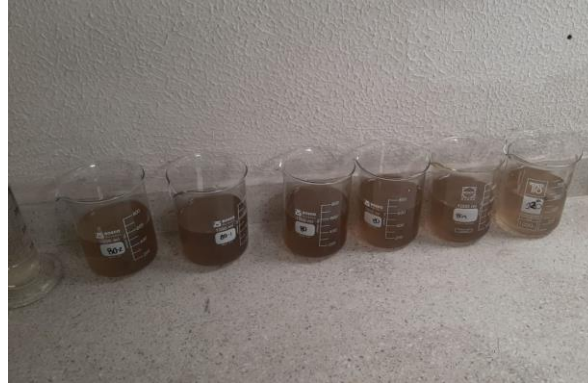
Fig. No 34, Muestra agua antes de filtración
