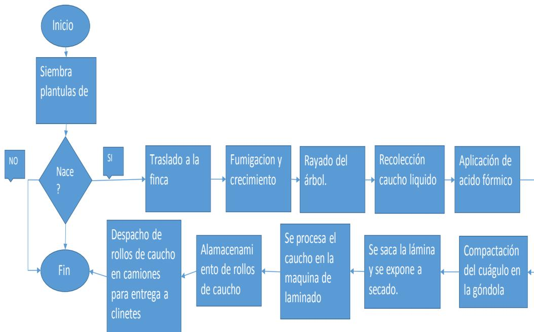
Figura 13. Flujo de Procesos. Fuente: Diseño propio
