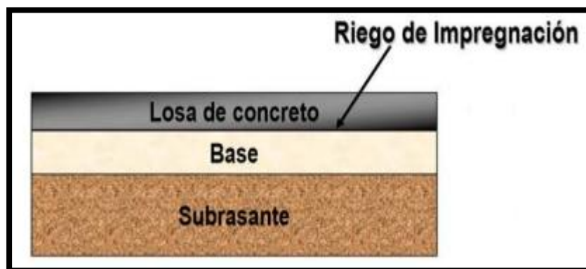
Ilustración 12 Estructura de Pavimento Rígido.
