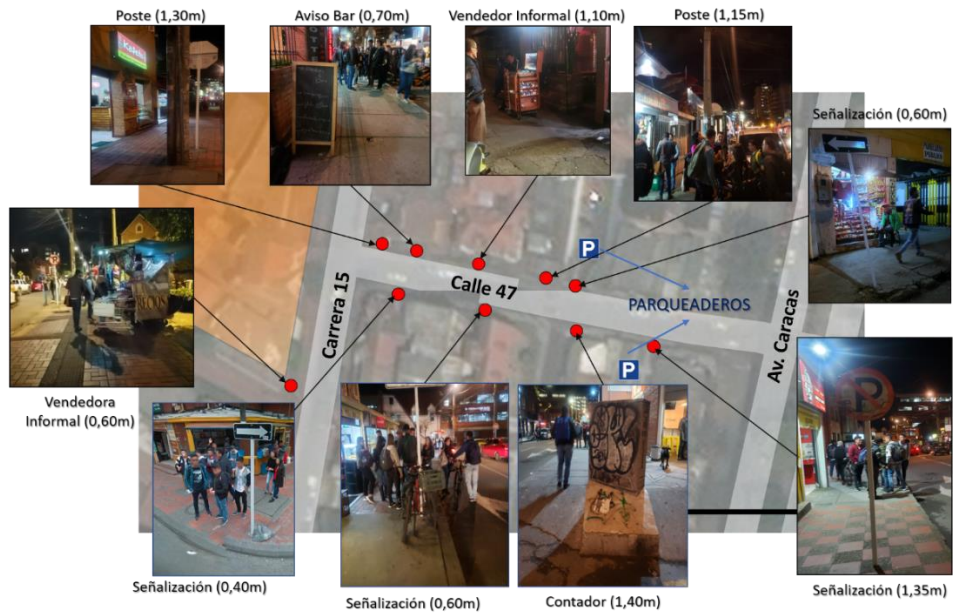
Ilustración 16. Inventario de Obstáculos Calle 47 entre Av. Caracas y Cra 15.
