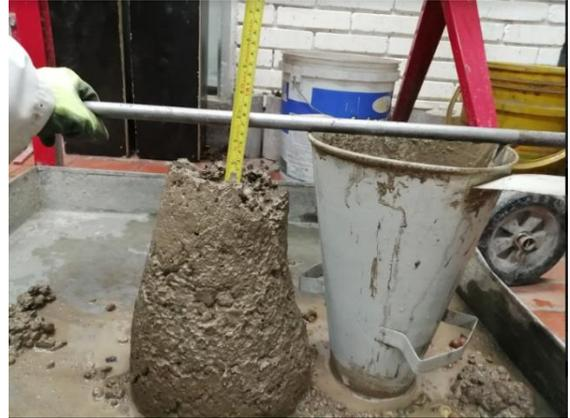
Fotografía 6. Asentamiento de la mezcla- Prueba de cono de Abrams
