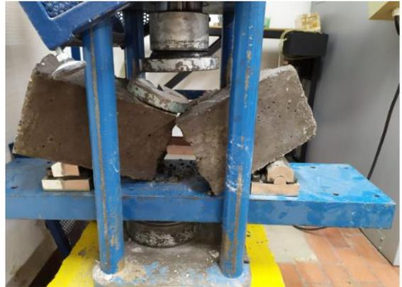
Fotografía 12. Ensayo resistencia a la flexión
