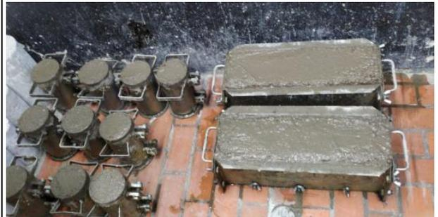
Fotografía 8. Cilindros y vigas en estado fresco
