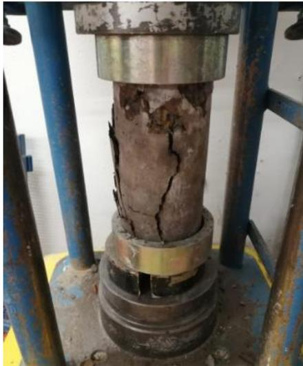
Fotografía 11. Ensayo resistencia a la compresión
