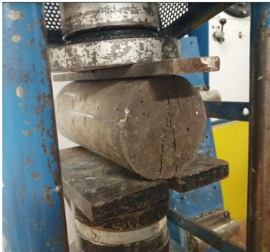
Fotografía 13. Ensayo resistencia a la tracción
