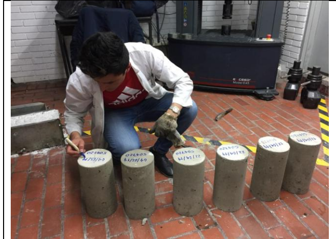
Figura 29. Marcado Cilindros para Fallar a 7-14-28 Días Concreto Inicial
