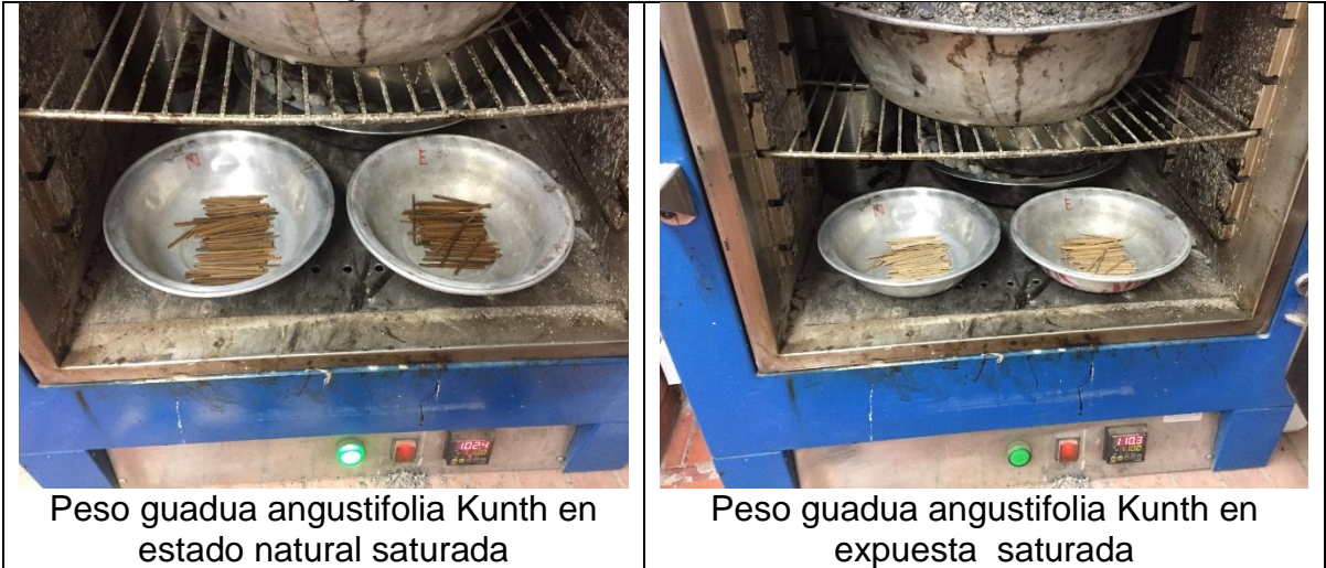
Figura 22. Fibras de Guadua Angustifolia Kunth Natural y Expuesta a Radiación UVB Después de Estar en el Horno 24 Horas
