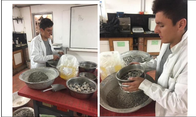
Figura 24. Alistamiento de Grava y Tamizado Material (Concrecol)
