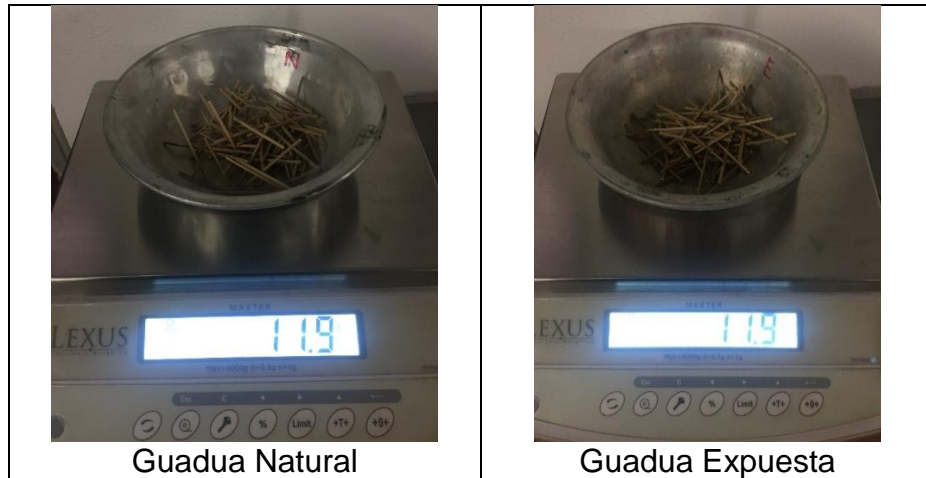
Figura 17. Fibras de guadua natural y expuesta a radiación UVB durante 17 días – peso inicial
