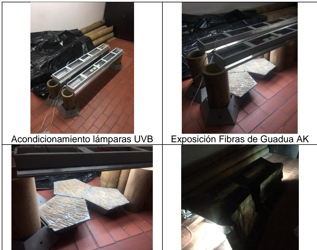
Figura 14. Acondicionamiento y Exposición de la Guadua AK a Radiación UVB
