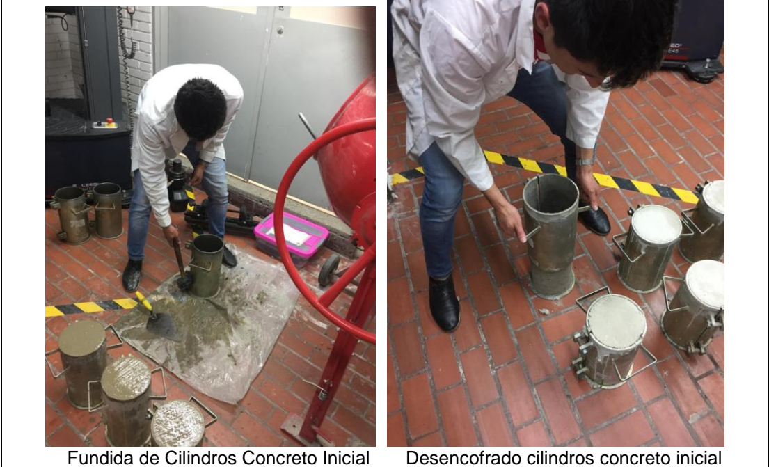
Fundida de Cilindros Concreto Inicial
