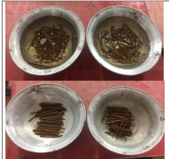
Figura 20. Fibras de Guadua Angustifolia Kunth Saturadas (Durante 24 Horas)
