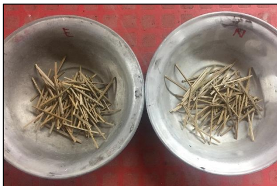
Figura 16. Diferencia coloración Fibras de guadua expuestas a radiación UVB - y fibras en estado natural
