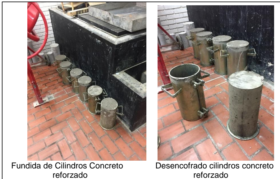
Figura 33. Fundida de Cilindros Concreto Reforzado con Fibras de Guadua AK.
