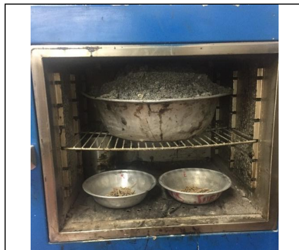
Figura 18. Fibras de Guadua Angustifolia Kunth Natural y Expuesta en el Horno
