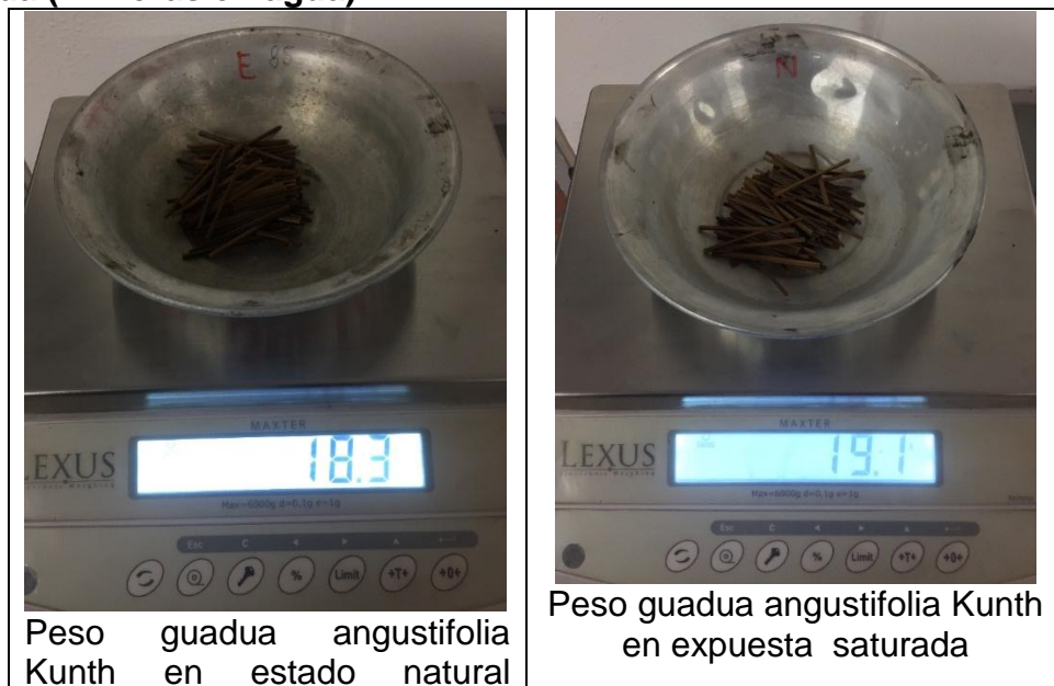
Figura 21. Peso guadua angustifolia Kunth expuesta a radiación UVB saturada (24 horas en agua)
