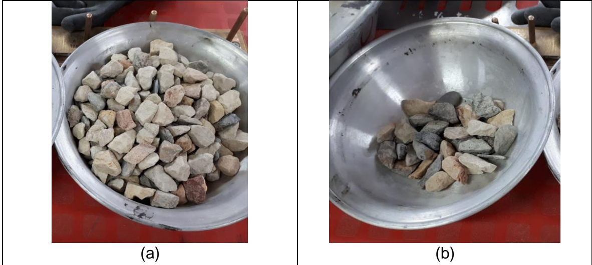
Figura 7. Base granular: (a) antes y (b) después de ensayar
