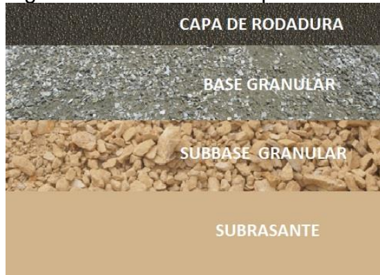
Figura 1. Estructura de un pavimento flexible
