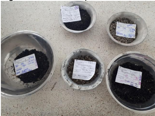
Figura 12. Muestras para verificación de humedad en ensayo CBR
