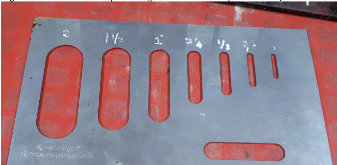
Figura 6. Calibrador de espesores (para el índice de aplanamiento)
