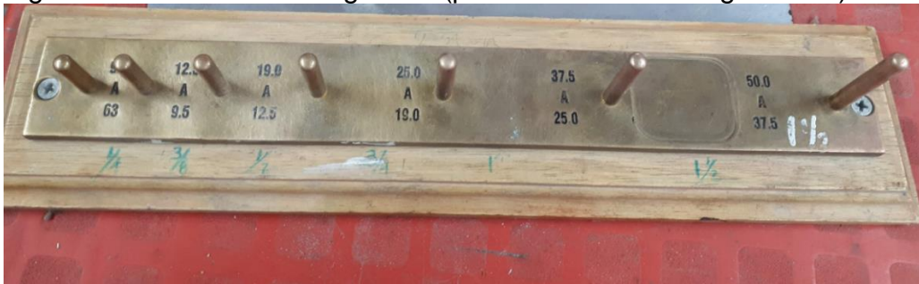
Figura 5. Calibrador de longitudes (para el índice de alargamiento)
