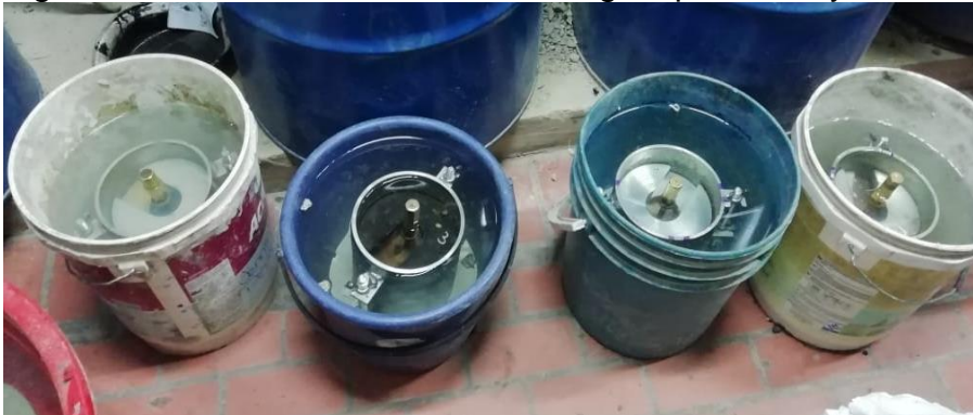
Figura 11. Muestras de material sumergido para ensayo CBR
