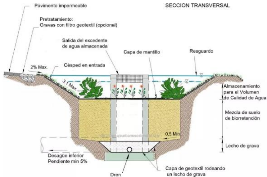
Figura 2-8. Esquema en corte de un área de biorretención Fuente: http://dreanjesostenible.org
