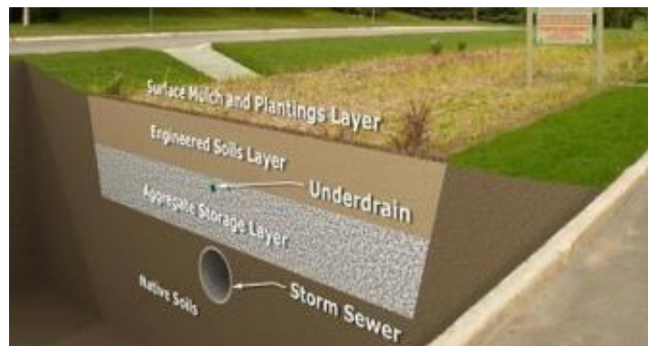
Figura 2-10. Esquema en corte de dren filtrante Fuente: Documento técnico de soporte SUDS – Alcaldía Mayor De Bogotá
