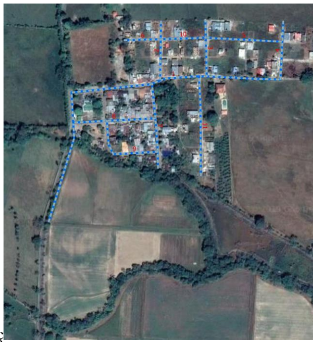
Figura 44 Red de conducción de aguas captadas a cultivos, Fuente: propia
