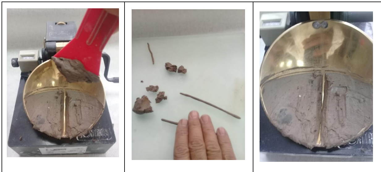
Foto 6-3 Límites de consistencia: Límite líquido y Límite Plástico.
