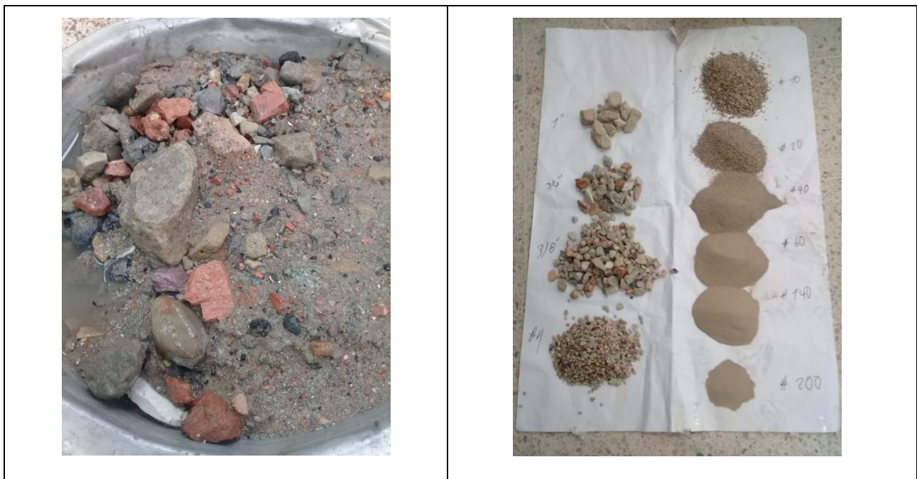
Foto 6-1 Granulometría del material (RCD)
