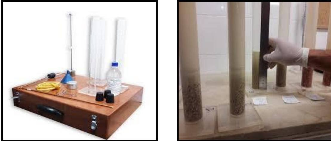
Fotografía 5. Ensayo equivalente de arena (Fuente: <https://twitter.com/cytemsl>)
