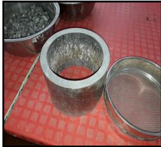
Fotografía 4. Ensayo de resistencia mecánica por método 10% de finos. (Fuente propia)
