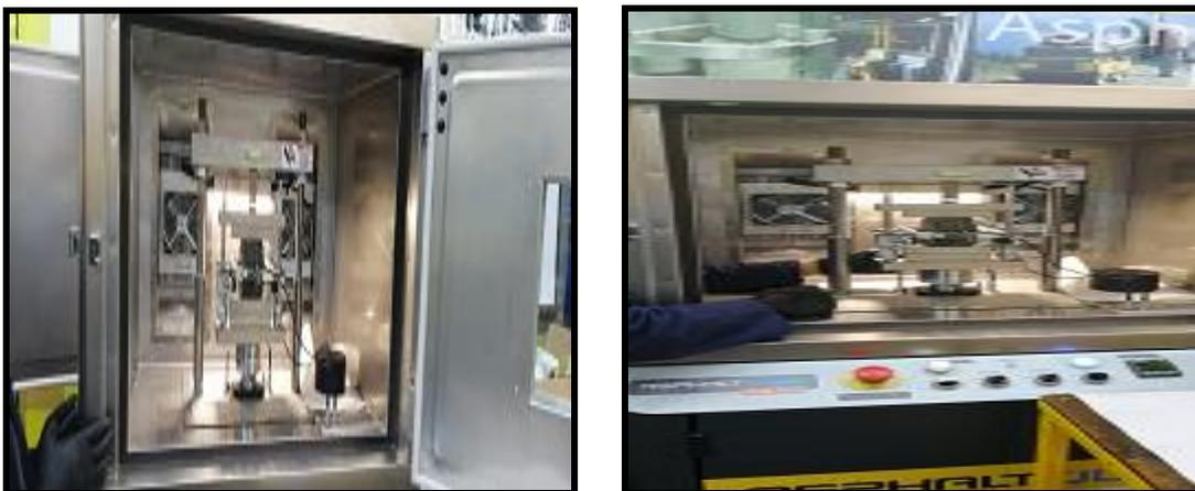
**Fotografía 7. Ensayo de módulo resiliente (MR) (Fuente propia)**
