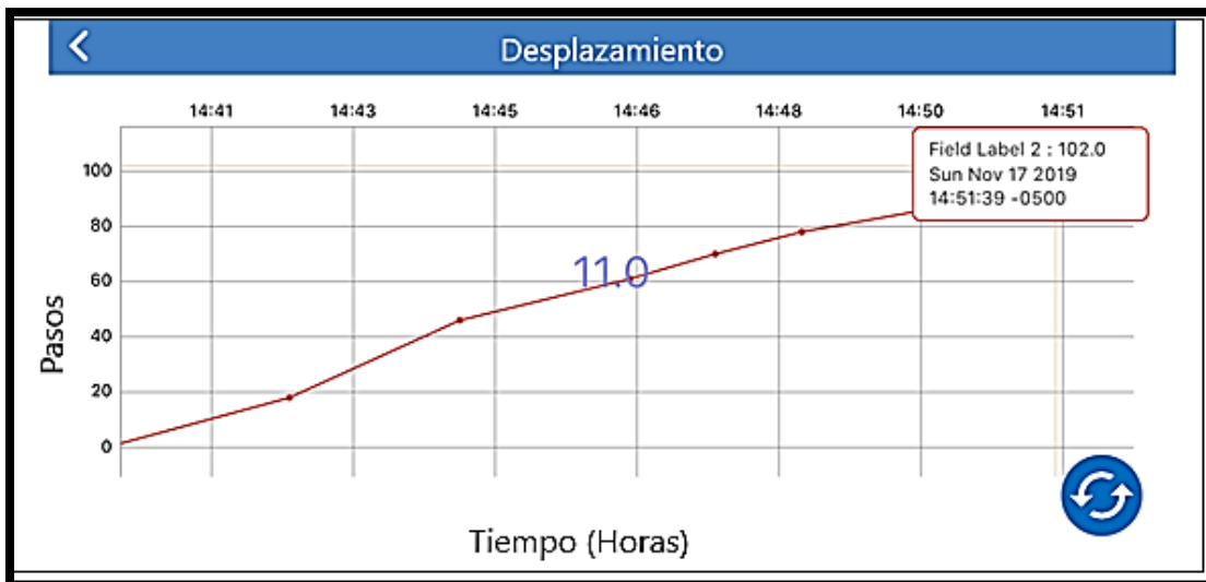
Figura 74. Datos de desplazamiento visualizados mediante la aplicación móvil de ThingSpeak.
