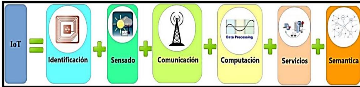
Figura 2. Los elementos de IoT.
