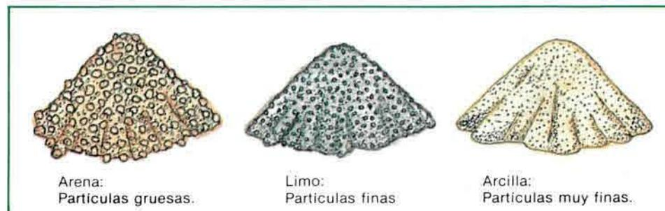
La textura del suelo puede determinarse frotando una pequeña cantidad de suelo entre los dedos. Los porcentajes de arena, arcilla y limo se obtienen en el laboratorio de suelos.
