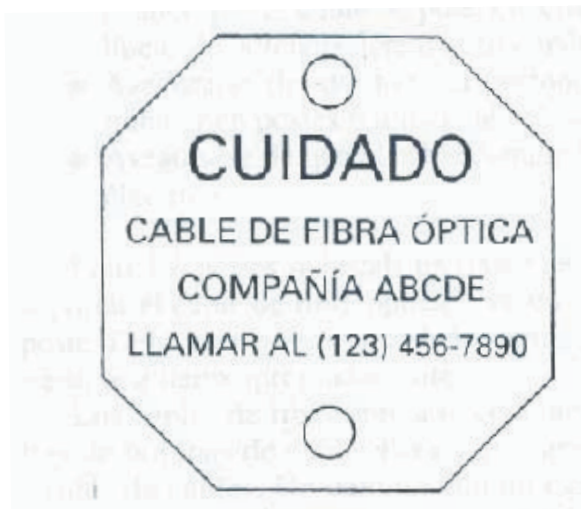
Figura 34. Etiqueta para identificar el cable en las cámaras o en interiores
