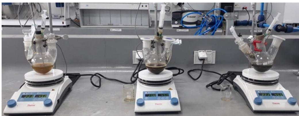
Figura 1. Montaje Experimental de síntesis de HVZ
