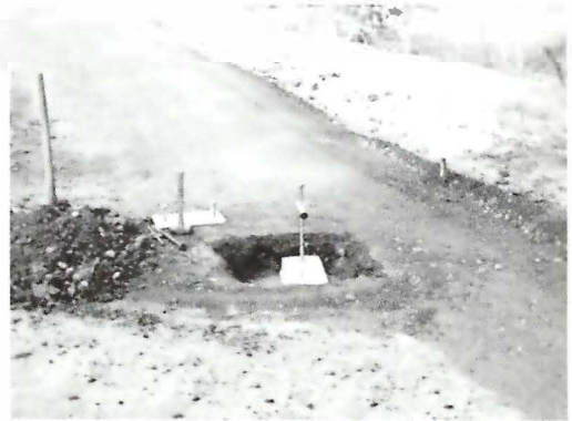
Fotografías 7 y 8. Deflexiones benkelman y densidades con densímetro nuclear
