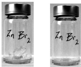
**Figura 9:** Cristal de  $\text{ZnBr}_2$  en condiciones ambientales de laboratorio. Primero, apenas se toma la muestra, luego de 5 minutos, dado que es una sal altamente higroscópica, solo se observa líquido.
