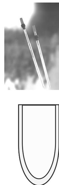
**Figura 6:** tubos de RMN concéntricos. En la parte exterior se coloca el solvente deuterado sin que interfiera con la muestra a medir.
