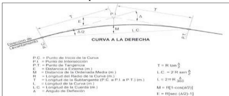
**RADIOS MINIMOS:** los radios mínimos de curvatura horizontal son los menores radios que pueden recorrerse con la velocidad de diseño y tasa de máxima peralte, en condiciones aceptables de seguridad y comodidad, para cuyo cálculo puede utilizarse la siguiente formula:
