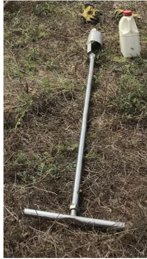
IMAGEN N° 02: Barreno utilizado en campo de 1.50 m con punta de 2”
