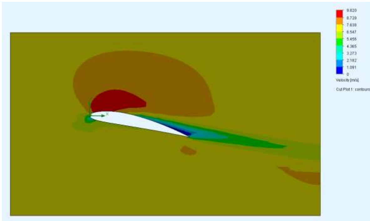
Figura N° 45: Contornos de velocidades del perfil NACA 4412
