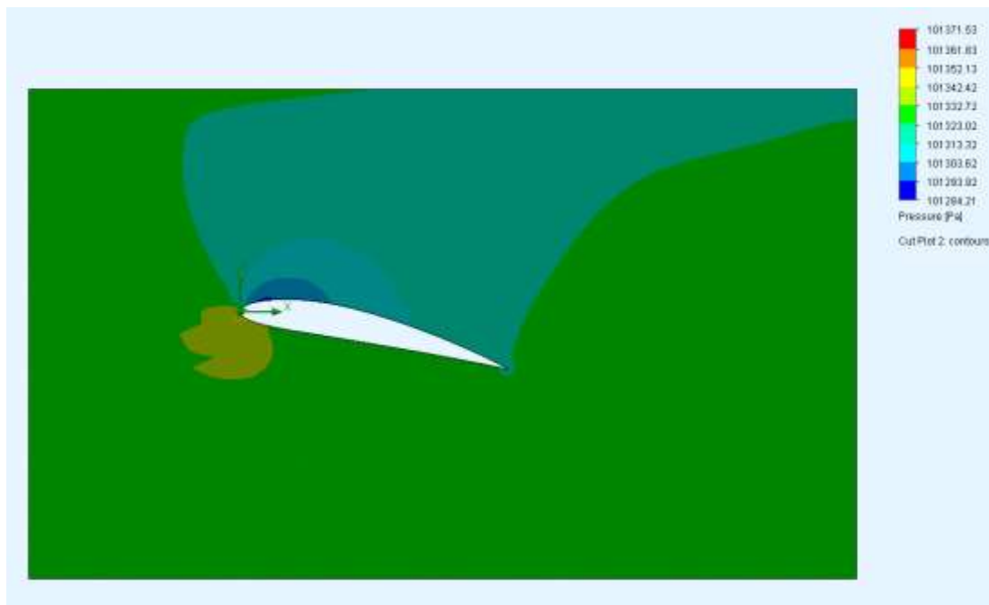
Figura N° 42: Contornos de presiones del perfil NACA 4412
