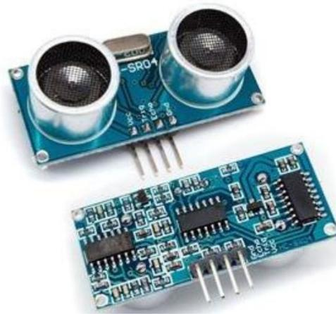
**Figura 17.** Sensores ultrasonicos.
