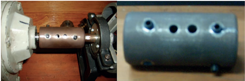
Figura 149. Acoples no estandarizados y excesivamente rígidos Tomado de [3]
