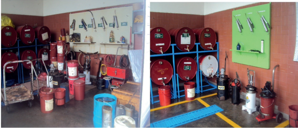
Figura 94. El antes y el después al aplicar Seiton a un taller de lubricación Tomado de [54]
