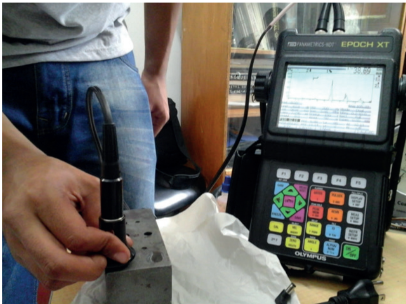
Figura 78. Aplicación de ultrasonido para detección de defectos o discontinuidades. Tomado de [3]
