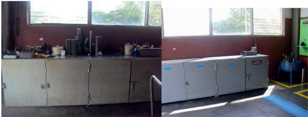
Figura 96. El antes y el después al aplicar Seiso a un taller de lubricación Tomado de [54]
