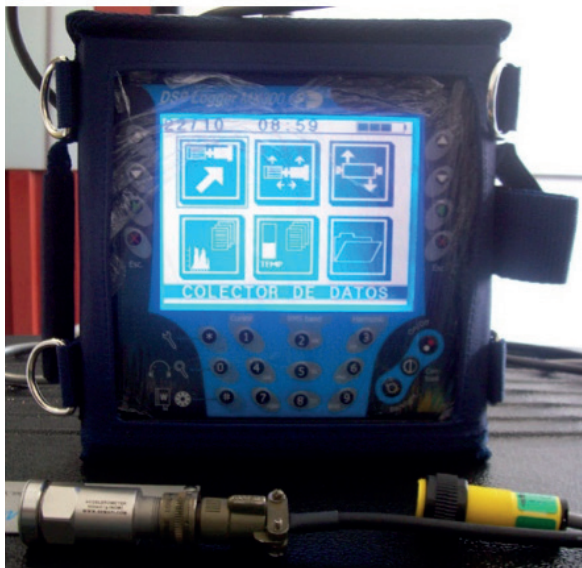
Figura 64. Equipo para medición y análisis de vibraciones UTP. Tomado de [3]
