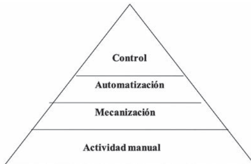
Figura 1. Pirámide de la Automatización
