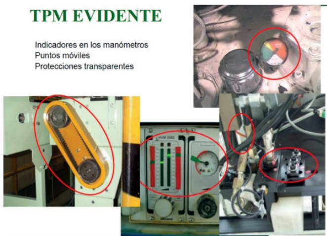
Figura 101. Ejemplos de inspección autónoma Tomado de [8]
