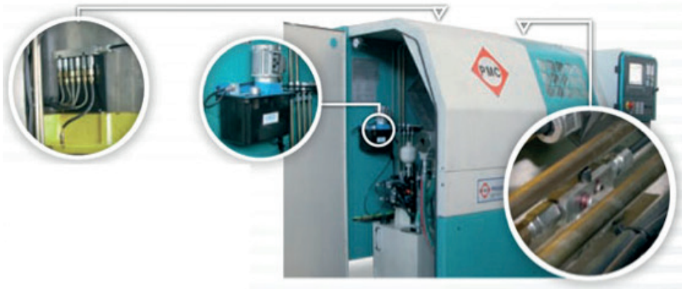
Figura 166. Sistema de lubricación centralizado aplicado en torno CNC Tomado de [97]
