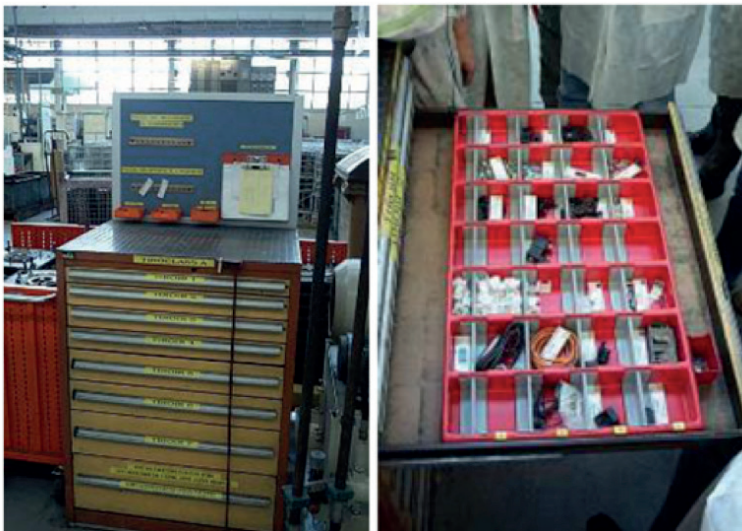
Figura 95. Ejemplo de aplicación de Seiton para organizar repuestos Tomado de [8]
