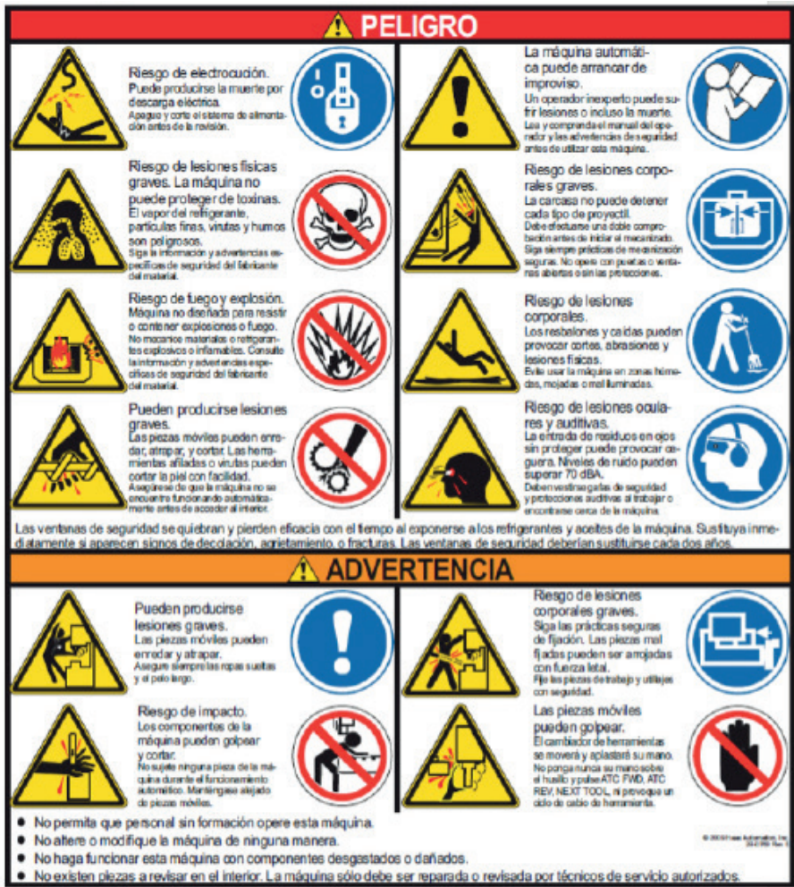
Figura 135. Riesgos al hacer uso de un centro de mecanizado Haas VF-2 Tomado de [3]
