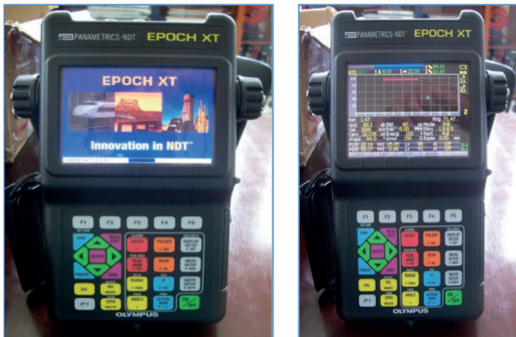
Figura 76. Equipo Panametrics EPOCH XT, detector de discontinuidades por ultrasonido Tomado de [3]
