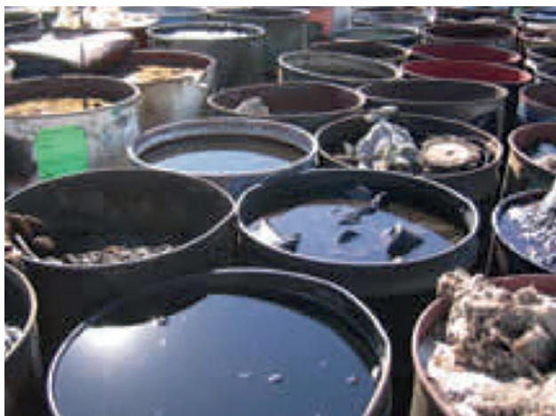
Figura 144. Almacenamiento inadecuado de productos RESPEL. Tomado de [81]
