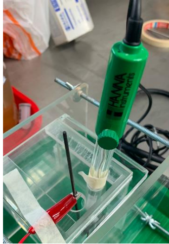
Figura 14. Electrodo de referencia (verde) y contraelectrodo (rojo). Fuente: [AUTORES]
