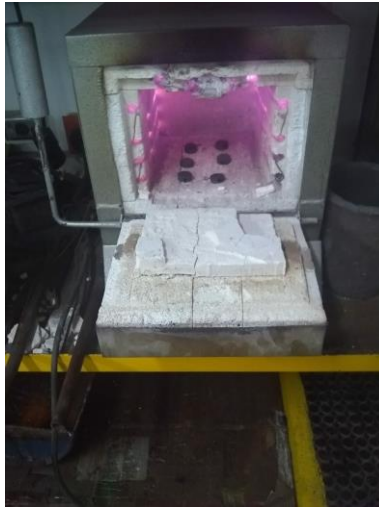
Figura 11. Tratamiento Térmico de Temple en horno. Fuente: [AUTORES]
