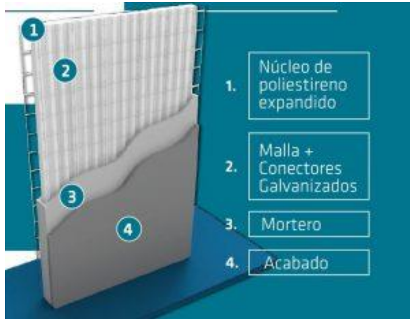
Figura 15. Durapanel con mortero y acabado. Fuente: Edificio Quimbaya ( http://edificioquimbaya.com/2018/08/04/sistema-constructivo-durapanel/ )
