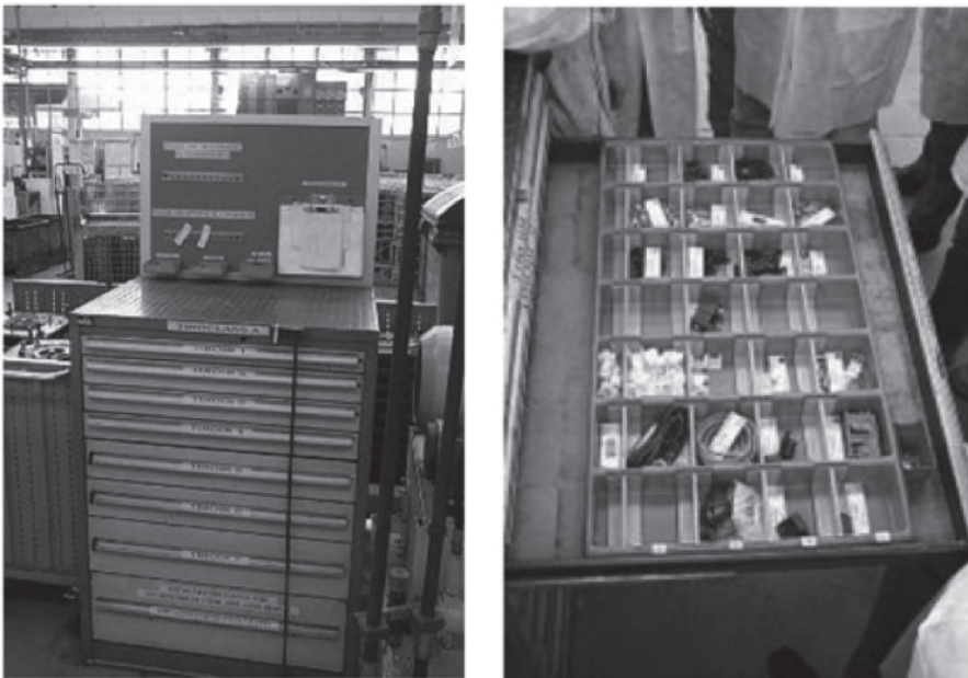
Figura 60. Ejemplo de aplicación de Seiton para organizar repuestos [6]
