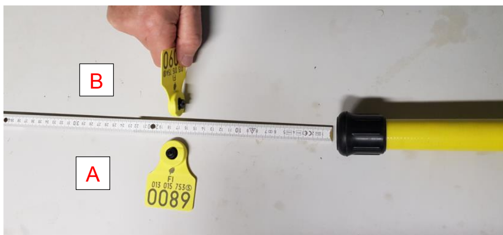
Kuva 2. Tunnistusetäisyyden mittaus antennin suuntaisesti, jonka aikana eMerkkiä pidettiin vuoron perään vaakaa- (A) ja pystyasennossa (B).
