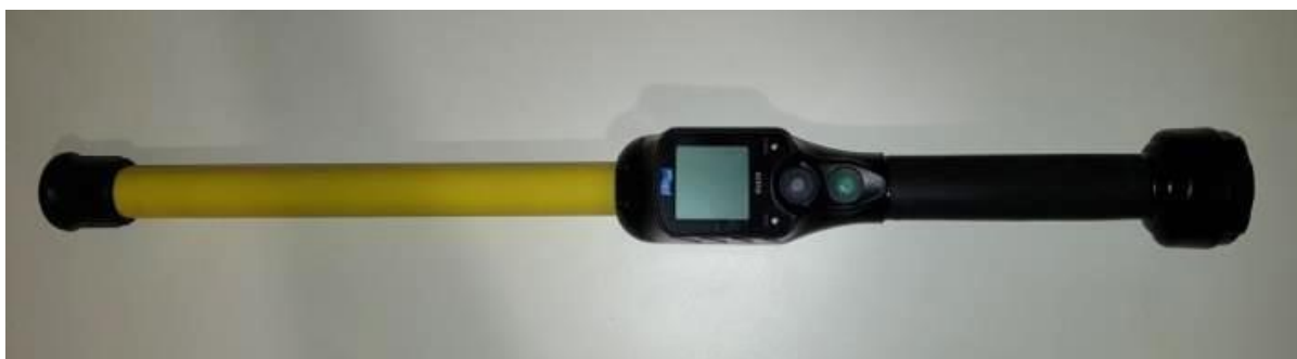
Kuva 6. Allflex RS 420-80 -lukijalaite.
