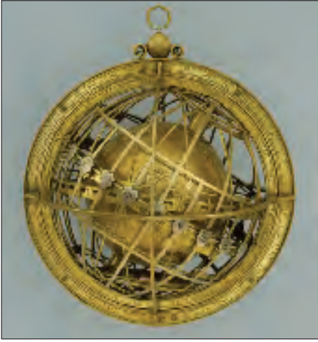
Ryc. 1.23. Sfera armilarna Globusu Jagiellońskiego. Globus jest precyzyjnym zegarem z kulą ziemską w środku i tzw. sferą armilarną. Obrót ażurowej sfery wraz ze słońcem-wskazówką pokazuje zmiany czasu w cyklu rocznym (kalendarz zodiakalny) oraz dobowym. Mechanizm zegarowy znajduje się w środku modelu Ziemi. Zbiory Muzeum UJ, opis wg materiałów Muzeum.
