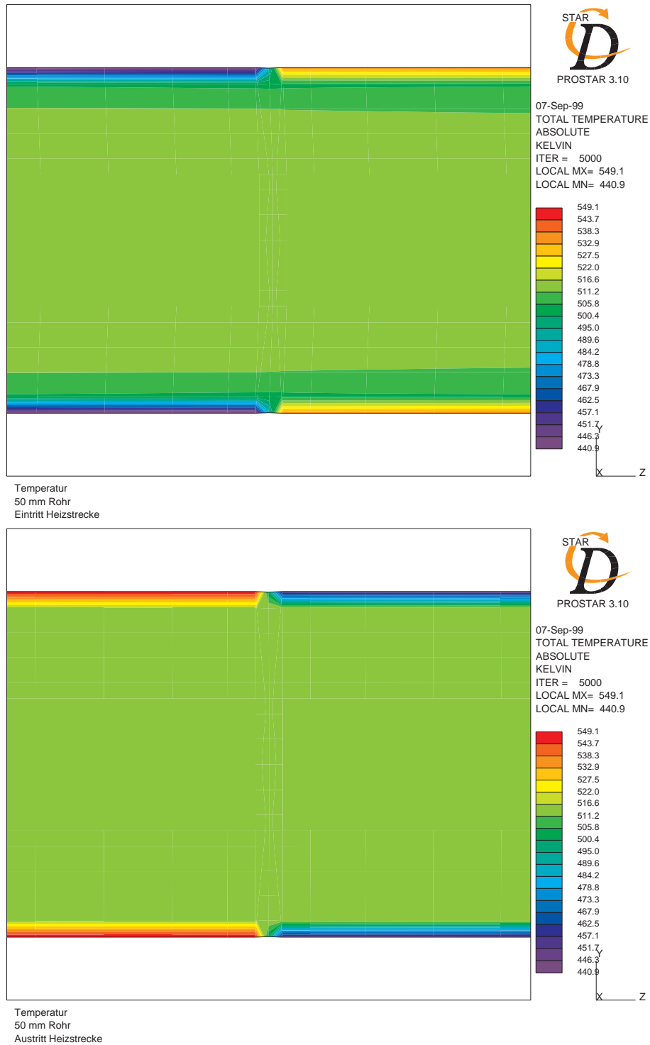
Abb. 8.5: Temperatur am Einlaß (oben) und Auslaß (unten) der Heizstrecke (Strömungsrichtung von links nach rechts (→))
